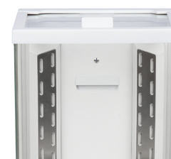
Jonizator antystatyczny wbudowany w komorę ważenia
