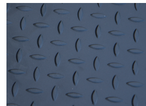
Wierzchnia część szalki pokryta blachą ryflowaną
