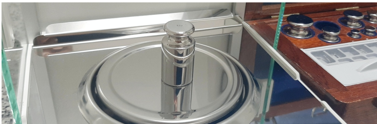
Rysunek 6. Kontrola odchyłki czułości wagi wzorcem masy
