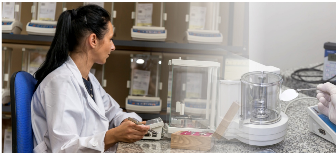
Rysunek 13. Kontrola metrologiczna wagi, pomiar masy filtra
