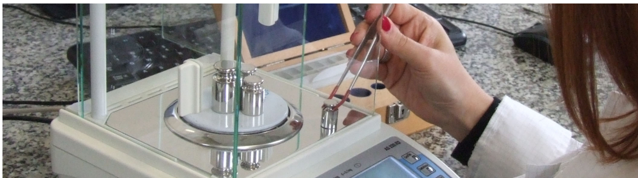
Rysunek 1. Dział Kontroli Jakości – waga AS 220.R2, ocena poprawności wskazań
