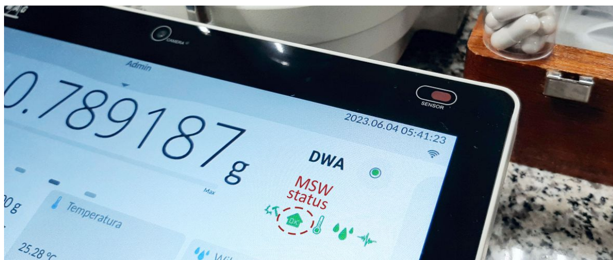
Rysunek 9. Mikrowaga MYA 5.5Y z aktywną Funkcją MSW
