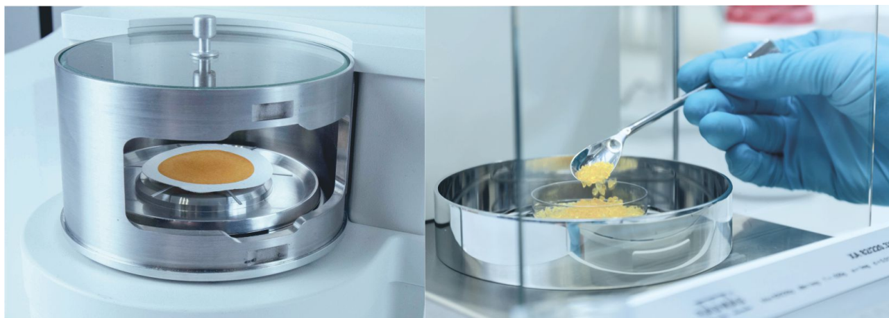
Rysunek 8. Badanie zmian masy filtra po procesie sączenia, odmierzanie ilości substancji
