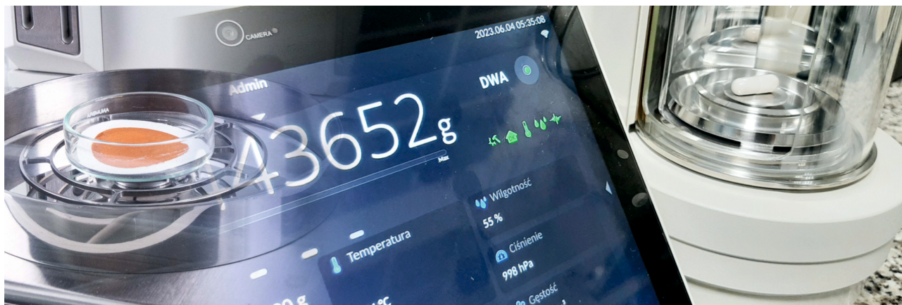
Rysunek 11. Waga XA 82/220.5Y, pomiar masy filtra, Mikrowaga MYA 2.5Y, pomiar masy kapsułki – jednolitość masy preparatów medycznych (USP)
