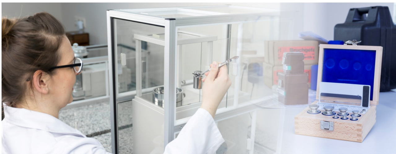
Rysunek 2. Wzorcowanie metodą manualną komparatora masy
