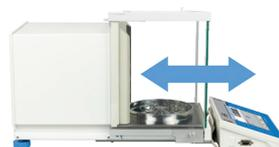
Chambre de pesage avec le système d'ouverture automatique
