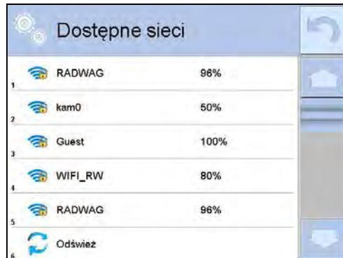
L'icône, visible à côté du nom du réseau, montre ce que le réseau demande l'introduction du mot de passe. Pour trouver les réseaux accessibles, choisir l'option *<Rafraîchir>*.
