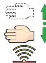
Le paramètre à l'échelle 0 – 9 décide à quelle distance les senseurs réagiront.
