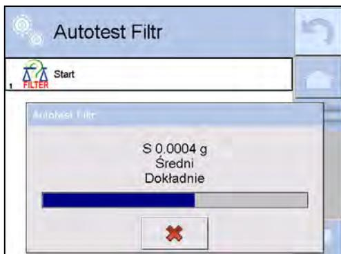
L'utilisateur peut interrompre la réalisation du processus à n'importe quel moment par la pression sur la touche <X> dans la fenêtre du processus.
