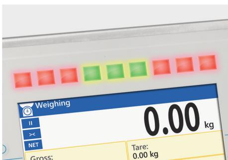
Bargraphe – se compose de 9 champs à diode, se trouve dans la partie supérieure d'un afficheur et présente graphiquement une masse actuelle.
