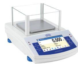
Écran de protection anti-courant d'air pour la balance PS 3000.X2
