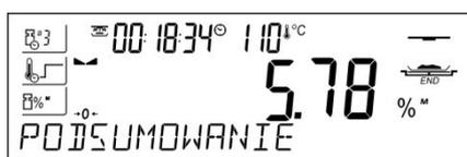
processus de séchage, le rapport est affiché et le résultat final de l'humidité est verrouillé.
