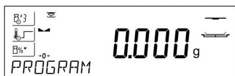
Dans sa partie gauche, l'afficheur montre, à l'aide des pictogrammes, les réglages choisis pour le processus de séchage.
