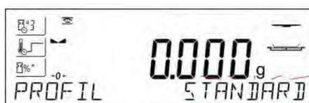
Après l'entrée dans les réglages des paramètres de séchage, le logiciel affiche le nom <PROFIL> dans la barre inférieure et l'inscription clignotant qui signifie le type du profil. À l'aide des touches fléchées choisir le profil convenable et valider le choix par la touche ENTER. Après la validation du choix, le logiciel passera automatiquement aux réglages des paramètres qui dépendent du profil choisi.
