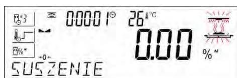
L'afficheur montre les informations sur le séchage et le dessiccateur effectue automatiquement le processus de séchage, conformément aux
