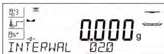
L'intervalle du temps entre les impressions suivantes de mesures pendant le séchage est introduit en secondes dans l'étendue de 0 à 120 s.
