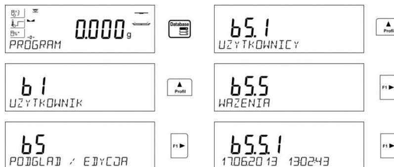
Chaque mesure est enregistrée sous son numéro individuel. Le format du numéro a la forme: b4.4.n, où <n> est le numéro suivant de la mesure enregistrée. Dans la barre inférieure, pour chaque mesure sont affichés la date et le temps de la réalisation.
