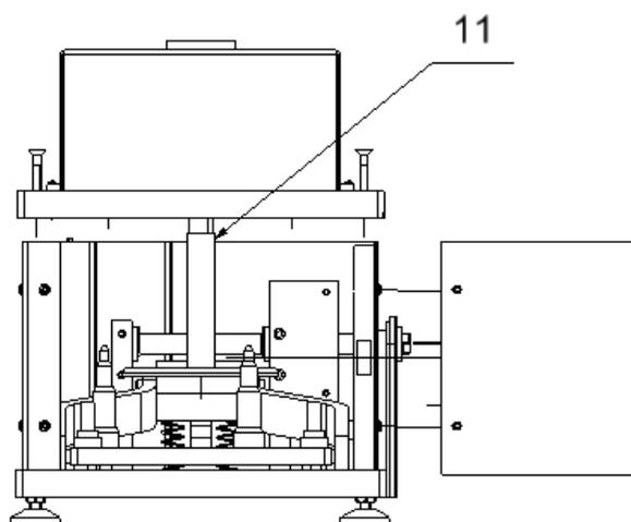
3. Enlever la plaque (12), l'espace entre la plaque (12) et le connecteur du plateau inférieur (11) utiliser pour mettre les poids (13) sur les positionneurs (14). Visser la plaque (12) à l'aide des vis M6 (10). Dévisser 6 vis M3 (15) et enlever la protection du mécanisme (16).
