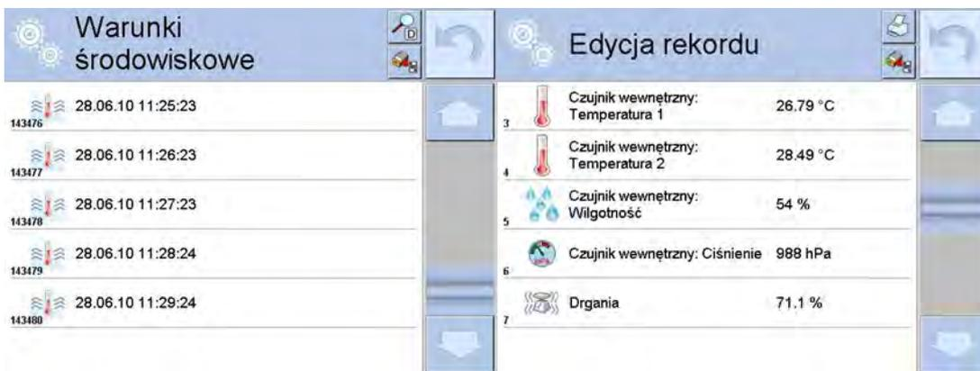
La valeur RMS des vibrations est enregistrée, enregistrée par la balance dans une période de temps déclarée (depuis le dernier enregistrement) - Configuration / Environnement / Fréquence d'enregistrement des conditions.
