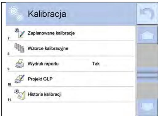
Entrez dans le menu utilisateur, groupe de paramètres <Calibrage> et recherchez le paramètre <Calibrages programmés>.
