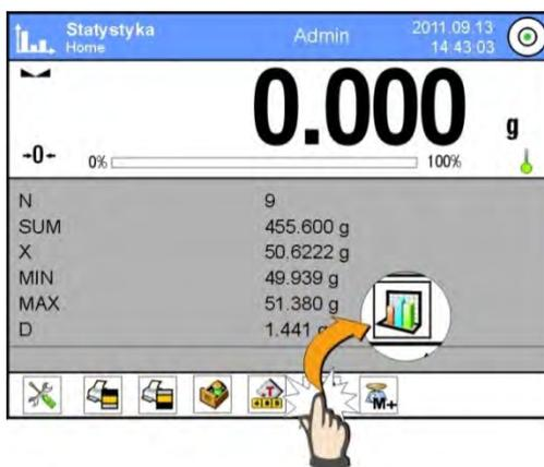
2. L'afficheur montrera les options: Résultat, Imprimer, Supprimer la dernière mesure, Supprimer, Liste des mesures, Diagramme de probabilité.
