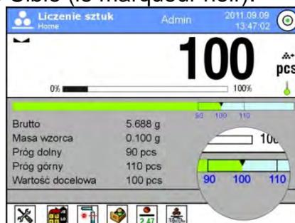
**Remarque:** Les fonctions: Contrôle de Tolérances et Dosage peuvent fonctionner en même temps pendant le comptage de pièces. Dans ce cas le rôle de la tolérance du dosage remplissent les seuils Lo et Hi du Contrôle de Tolérances.
