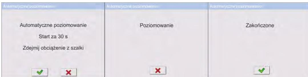
La plage de nivellement est limitée. Si la surface de la table sur laquelle la balance a été placée présente une pente trop importante et que la plage de nivellement est terminée, le processus sera interrompu et un message apparaîtra à l'écran.
