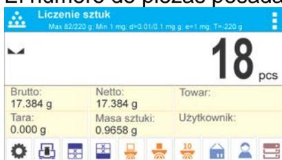
Puede imprimir una medida estable (se muestra un pictograma de estabilidad), para hacerlo presione la tecla
