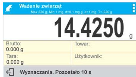
3. Después de terminación la determinación la pantalla muestra el resultado de pesaje del objeto "cerrado", y se imprimirá automáticamente el peso de la impresora conectada.
