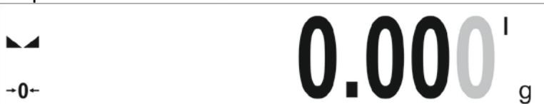
La balanza vuelve al modo de pesaje con una precisión  $d_1=0.001g$  y se apaga el símbolo **II** de marcador sobre el penúltimo dígito
