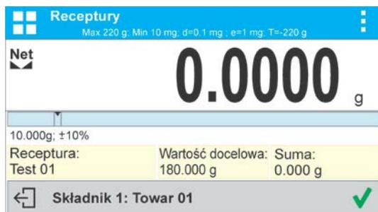
En la parte superior del campo de la información muestra barra gráfica, que se muestra el peso del ingrediente que se pesó. Color de relleno de gráfico de barras puede variar dependiendo de la cantidad de componente situado. (descripción de barógrafo se encuentra en la sección de modo DOSIFICACIÓN ).
