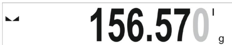
El paso de la exactitud de pesaje de **I limite** de pesaje con una precisión de **II limite** se realiza automáticamente después de pasar Max<sub>1</sub> 200g (sin usuario). Después de entrar en la zona de pesaje con precisión de **II limite** en la pantalla se muestra el símbolo **II** de la parte derecha de la pantalla y un marcador adicional del penúltimo dígito.
