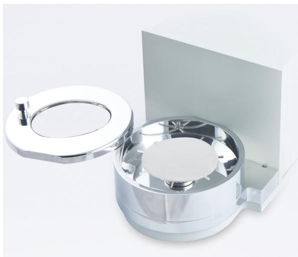
Pesaje de filtros usando microbalanza MYA 4Y.F
