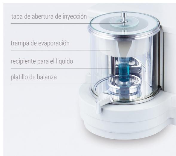
Microbalanza MYA 4Y.P, para calibración de pipetas
