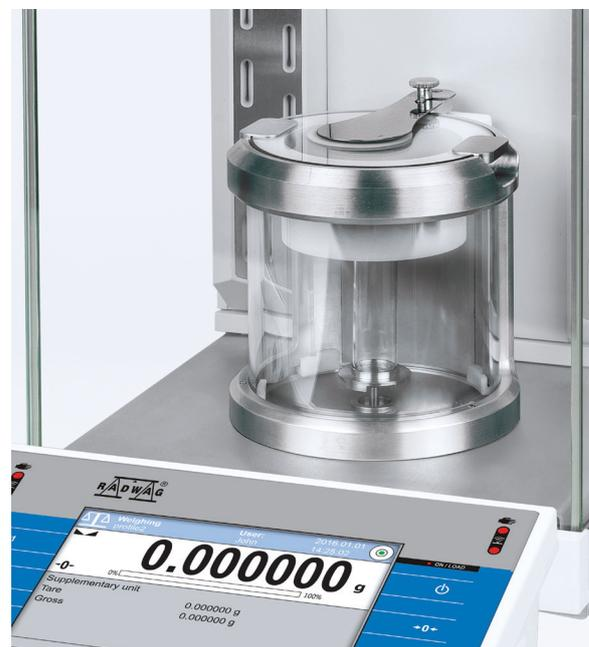
Microbalanza XA 4Y.M.A.P para calibración pipetas con una tapa de apertura automática del agujero de dispensación.
