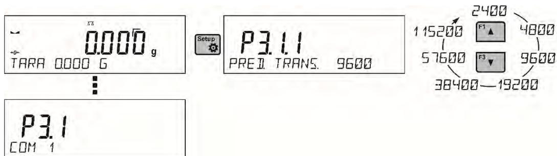
Para los ajustes de los puertos RS 232 el programa de balanza tiene los siguientes parámetros de transmisión:
