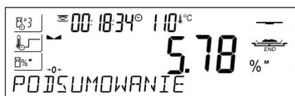
Al finalizar el proceso de secado, se muestra el resumen de la prueba, y el resultado final del contenido de humedad
