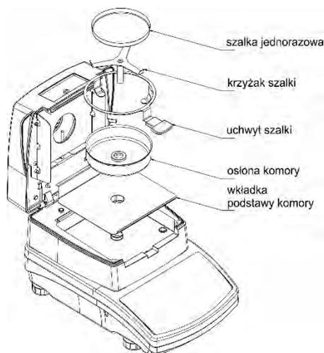
Abra la tapa del analizador de humedad y retire todos los componentes: platillo desechable, mango de la bandeja de secado, soporte en forma de cruz, protector de la bandeja de secado, inserto de la base de la cámara de secado. Para la limpieza, use un material delicado (tetra, gamuza, etc.) y agentes de limpieza suaves.
