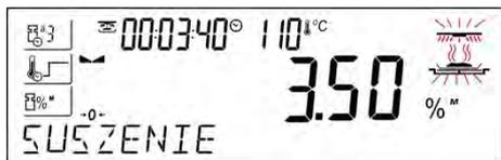
Durante el secado, los resultados de la medición actual y la información sobre el proceso en sí aparecen en la pantalla (tiempo de prueba, temperatura de la cámara, etc.).
