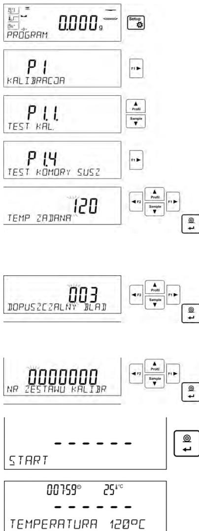
Para iniciar el procedimiento, hay que entrar al submenú **<P1Calibración>**, y luego inicie el procedimiento **<P1.4 Prueba de cámara de secado>**
