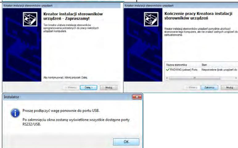
2. Después de instalar el controlador, conecte la balanza a un ordenador mediante un cable USB A / B no superado 1,8 metros (si la balanza ha sido conectada anterior al ordenador , desconecte y vuelva a conectar el cable USB).
