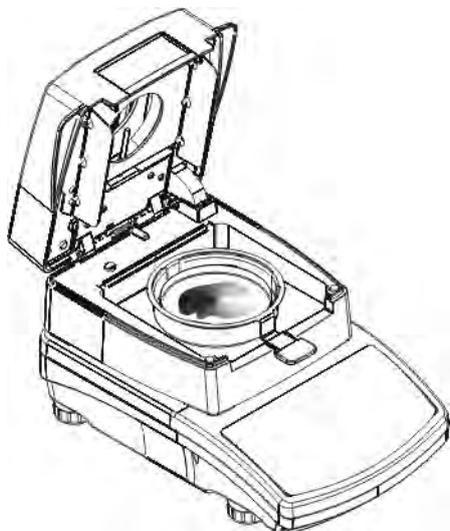
En el platillo hay que poner la muestra. El peso de la muestra se seleccionará en función de la experiencia previa y las características del material probado.
