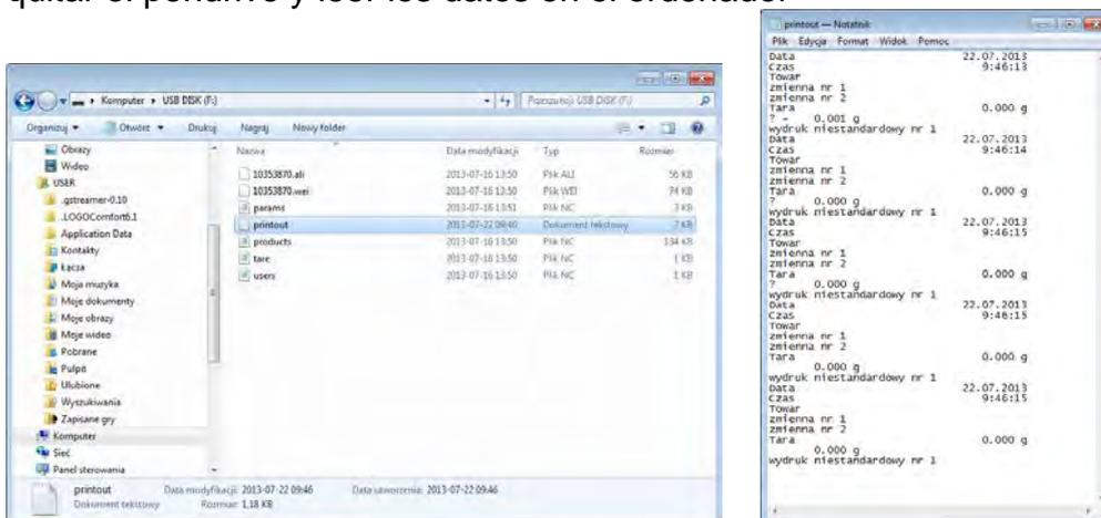
Después de volver a colocar el pendrive en USB, el programa de pesaje agregará datos al archivo ya creado en el pendrive, para que el usuario pueda continuar guardando las mediciones en el mismo archivo.
