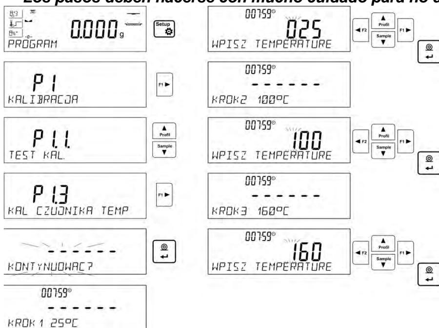
Ingrese al menú **<P1.3 KAL. CZUJNIKA TEMP>** seguido del mensaje **<Continuar?>** después de su aprobación, comenzará el proceso de calibración del sensor de temperatura de la cámara de secado.
