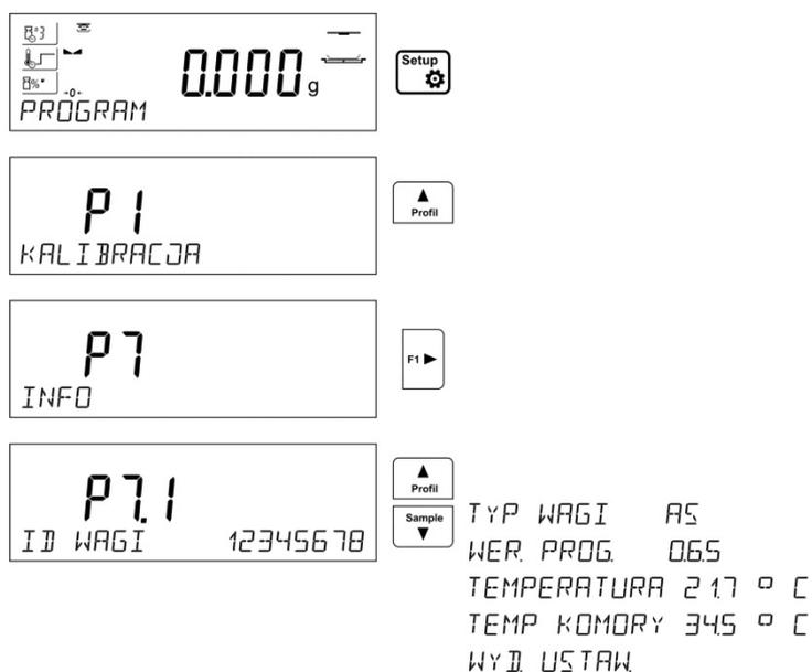
Después de seleccionar el parámetro <Impresión de los ajustes > se enviarán a la impresora los ajustes de la balanza (todos los parámetros) Los parámetros se enviarán a través del puerto seleccionado para <IMPRESORA>.
