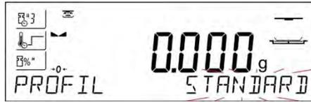
Después de entrar a los ajustes de los parámetros del secado, el parámetro muestra en la línea inferior el nombre <Perfil > y parpadea, indicando el tipo de perfil. Use los botones de flecha para seleccionar el perfil apropiado y confirme su elección presionando ENTER. El programa pasará automáticamente a la configuración de parámetros
