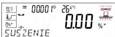
Se muestra información sobre el proceso de secado, el analizador de humedad procede a llevarlo a cabo según los parámetros establecidos. Se realizan las mediciones de masa requeridas y los cálculos del contenido de humedad de muestra probado, en donde los cálculos son el resultado de un cambio de masa.
