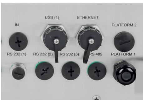
La parte trasera de la carcasa tiene conexiones herméticas para interfaces de comunicación.
