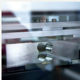
Sensor de medición extensiométrico
