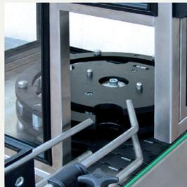
Alimentador rotativo de productos cilíndricos
