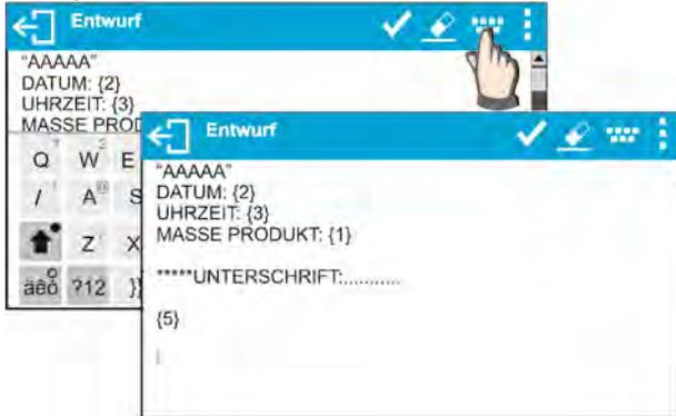
Um das Papier nach dem Drucken auf einem EPSON Drucker abzuschneiden (wenn Drucker mit einem Papiermesser ausgestattet ist), muss nach dem Ausdruck (KOPFZEILE, GLP oder FUSSZEILE) ein Sonderdruckbeleg mit der Variable {150} hinterlegt werden, dieser ist dann in den Einstellungen der Kopfzeile, des GLP Ausdrucks oder Fußzeile auszuwählen. (Das Prinzip der Eingabe der Steuerungscodes befindet sich im Punkt 25 der Bedienungsanleitung).
