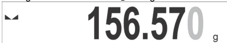
Der Wechsel vom Wägen mit Ziffernschritt des **I. Bereiches** zum Wägen mit Ziffernschritt des **II. Bereiches** erfolgt automatisch nach Überschreiten von  $\text{Max}_1$  200g (ohne Beteiligung des Bedieners). Nach dem Wechsel in den Wägebereich mit Ziffernschritt des **II. Bereiches** wird auf der rechten Seite der Anzeige das Symbol **II** angezeigt und die vorletzte Ziffer grau ausgegeben.
