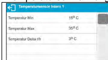
**Temperatur Min** – Wert der minimalen Temperatur in der Waage. Bei Unterschreitung der Temperatur wird ein rotes Symbol eines Thermometers angezeigt.
