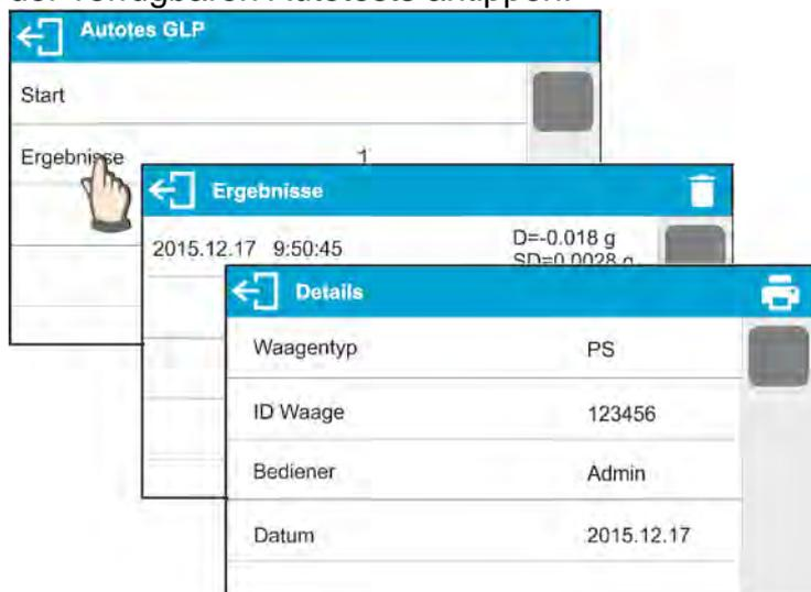
Im Fenster <Details> können Druckbelege nach Antippen des Druckersymbols in der oberen Fensterzeile ausgedruckt werden.
