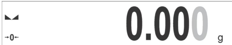
Die Waage kehrt zum Wägen mit Zifferschritt  $d_1=0,001\text{g}$ , das Symbol II wird ausgeblendet und vorletzte Ziffer wieder schwarz angezeigt.
