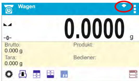
**Statussymbol der Verbindung mit dem WLAN Netz:**
