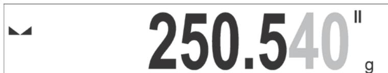
Die Waage wird ab jetzt mit dem Ziffernschritt des **II. Bereiches** arbeiten.
