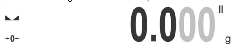
nachdem die angezeigte Masse auf null gestellt wird und Symbole angezeigt werden:  $\rightarrow 0 \leftarrow$  und  $\blacktriangle \blacktriangleleft$ , die Taste  $\rightarrow 0 \leftarrow$  betätigen.
