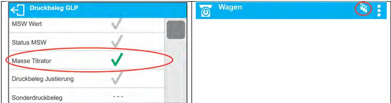
Nach dem Einschalten der Option wird in der oberen Zeile des Hauptfensters ein Symbol eingeblendet, das den Bediener über den speziellen Format des durch die Titratoren verwendeten Druckbelegs informiert.
