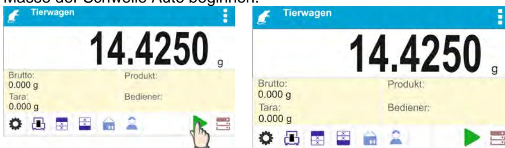
3. Nach Abschluss der Messung wird auf dem Display das „eingefrorene“ Ergebnis der Wägung des Objektes angezeigt und automatisch ein Druckbeleg auf dem angeschlossenen Drucker ausgegeben.
