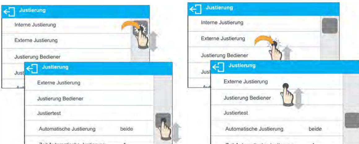
Scrollen im Parameterfenster. Beim gedrückten Schieber auf der linken Seite des Displays wird er nach oben bzw. nach unten verschoben, oder nach dem Antippen und gedrückt Halten eines beliebigen Punktes auf dem Display wird das Fenster nach oben bzw. nach unten verschoben.
