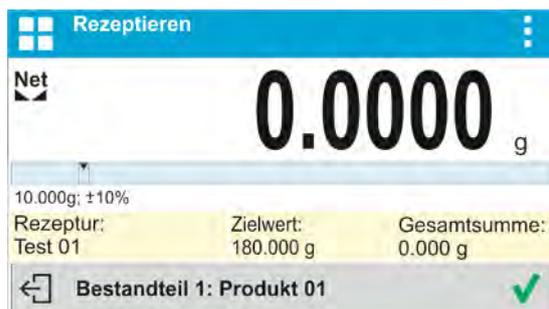
Im oberen Teil des Informationsfeldes wird ein Bargraph, darunter die Masse des einzuwiegenden Bestandteils angezeigt. Die Farbe des Bargraphen ändert sich in Abhängigkeit von der Menge des gewogenen Bestandteils (Beschreibung der Funktionsweise des Bargraphen ist im Punkt über die Betriebsart Dosieren).
