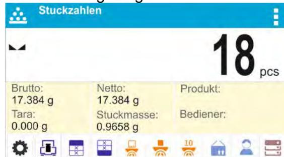
Nach Stabilisierung der Anzeige (Stabilitätszeichen) kann das Ergebnis nach Betätigen der Taste
