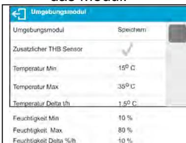
**Umgebungsmodul** - Parameter zum Bestimmen der Betriebsart des Moduls. Optionen: - - - – die Anzeige der Messungen des Umgebungsmoduls ist ausgeschaltet; **Schreiben** – die Anzeige und das Schreiben der Messungen in der Datenbank des Moduls ist eingeschaltet; **Schreiben und Alarm** – Anzeige und Schreiben der Messungen in der Datenbank, die Option der Anzeige von Warnungen über die Änderung der Umgebungsbedingungen nach den nachfolgenden Einstellungen der Grenzwerte ist eingeschaltet.
