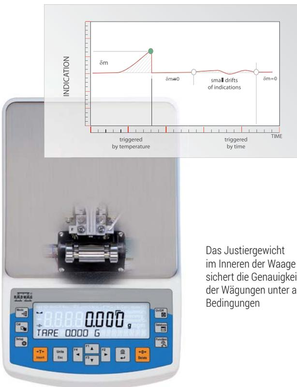
Das Justiergewicht im Inneren der Waage sichert die Genauigkeit der Wägungen unter allen Bedingungen
