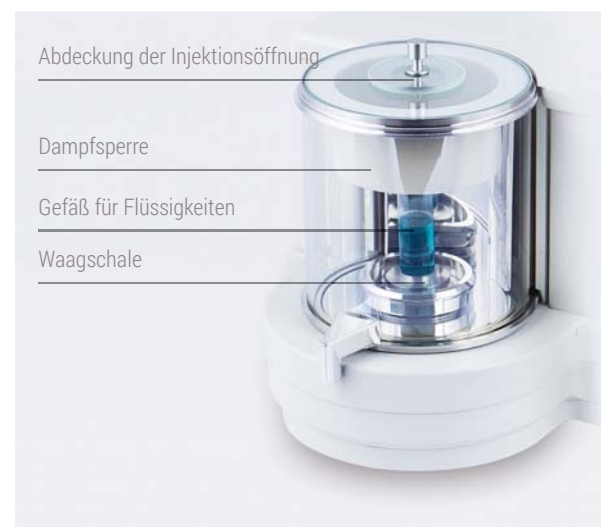
Mikrowaage MYA 4Y.P: Pipettenkalibrierung
