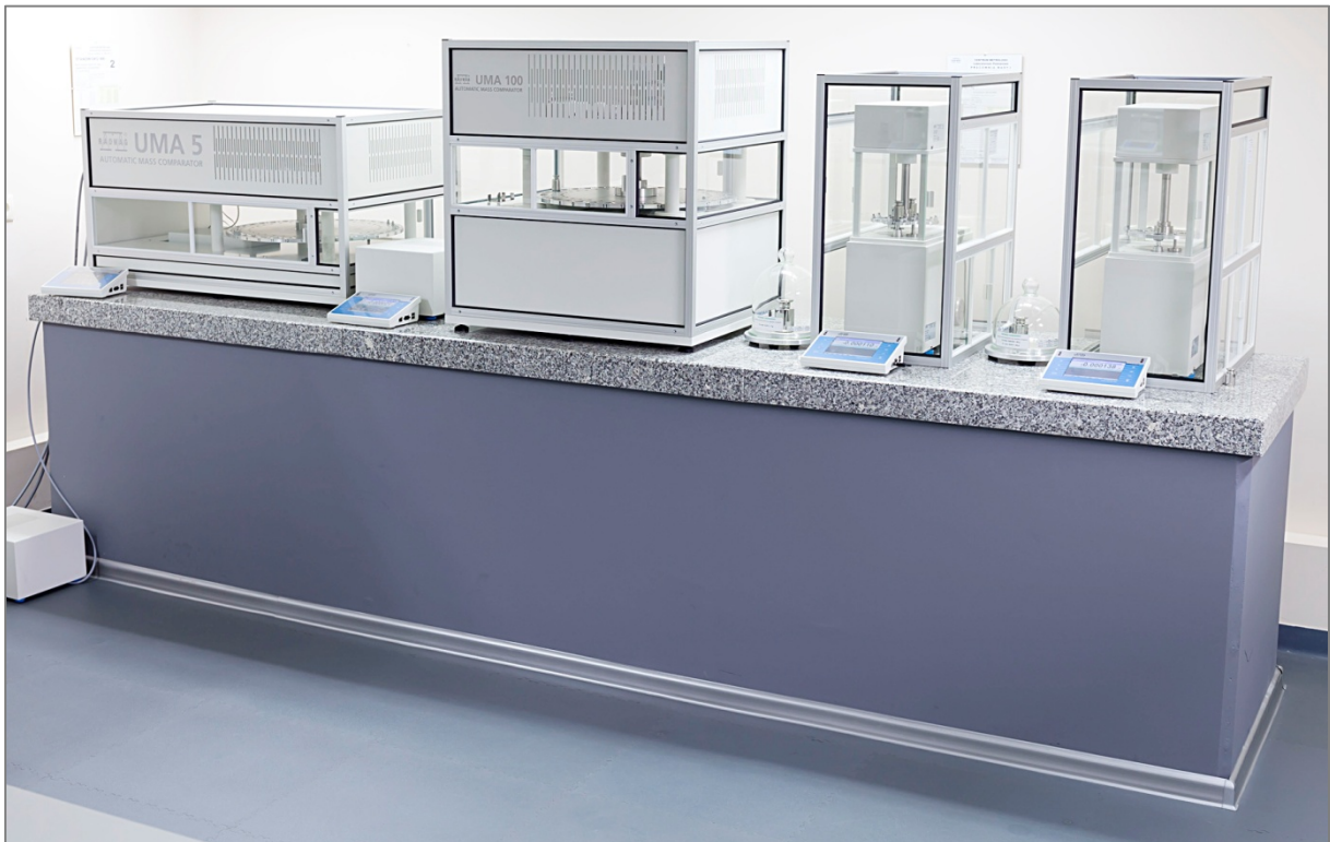
Betonowa konsola o masie własnej ponad 3 tony – komparacja z d=0,1 \mu\text{g}
