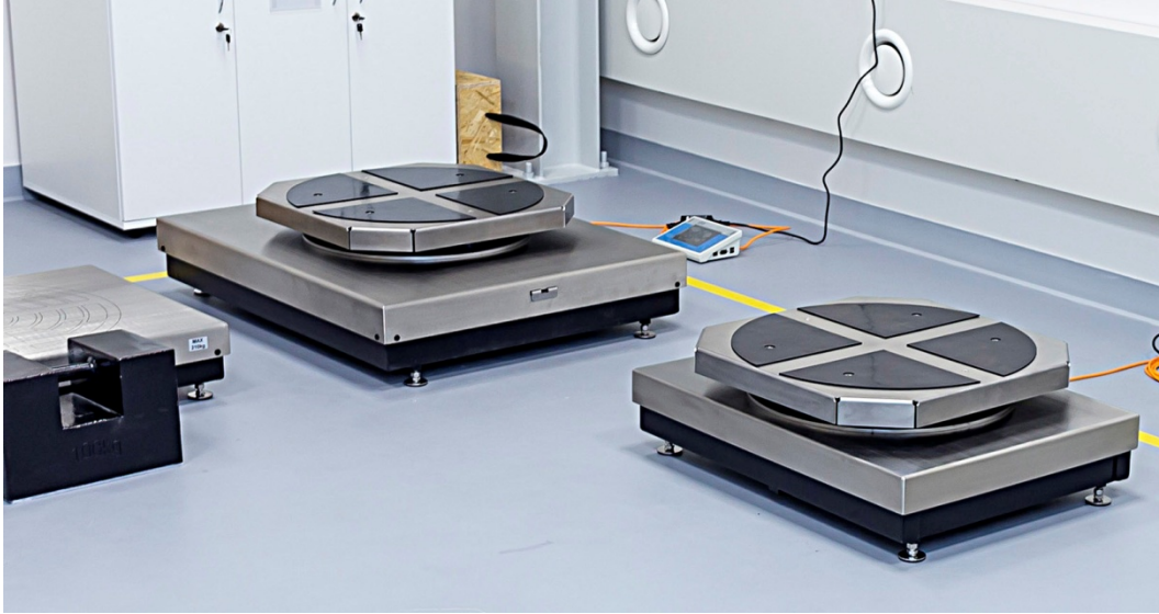
Przykład szalki samocentrującej, komparatory serii HRP
