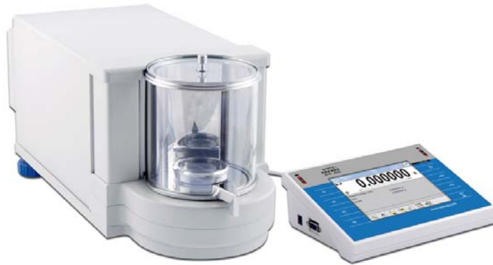
Komparator UYA 5.4Y.KO d=0,1 \mu\text{g} Obciążenie maksymalne 5 g, zakres równoważenia elektrycznego od 0 do 5,1 g Adjustacja automatyczna wewnętrzna, zakres komparacji 1 mg – 5 g
