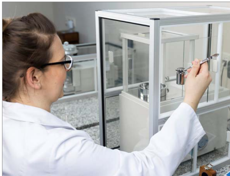
WAY 500.4Y.KO - komparator manualny, d = 10 \text{ }\mu\text{g}
