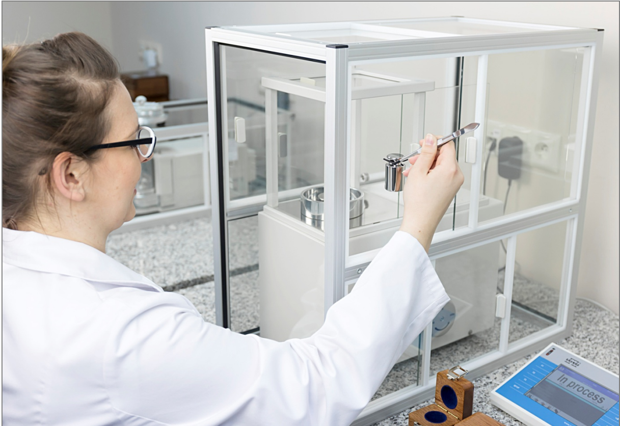
Proces komparacji manualnej – komparator z szafką przeciwpodmuchową
