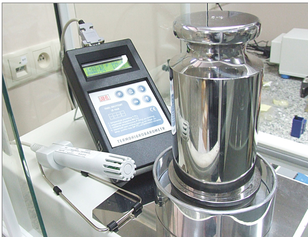
Pomiar temperatury, wilgotności oraz ciśnienia podczas komparacji
