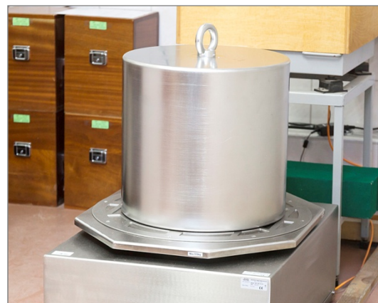
Komparator HRP 500.4Y.KO, d = 0,5 \text{ g} , zakres równoważenia od 0 kg do + 510 kg
