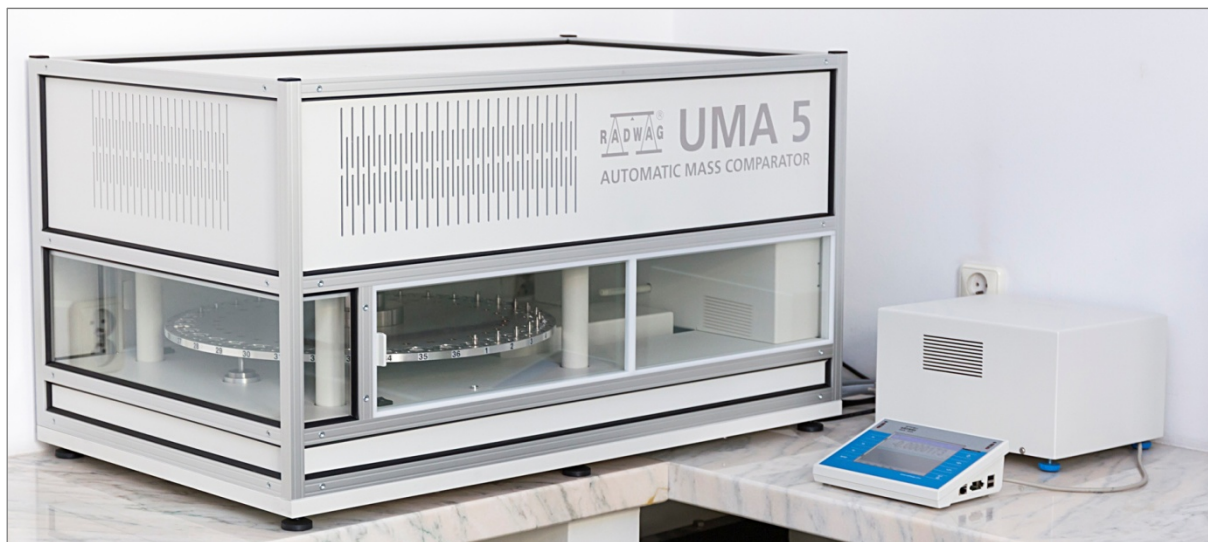
Automatyczny komparator masy – UMA 5, d = 0,1 \mu\text{g} , zakres równoważenia od 1 mg do 5 g
