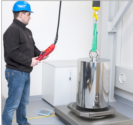
Komparacja wzorca 200 kg z wykorzystaniem szalki samocentrującej
