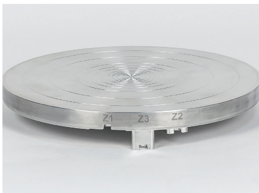
Szalca susceptometru dzięki specjalnej konstrukcji nie potrzebuje żadnych dodatkowych elementów do zmiany zakresu pracy urządzenia.
