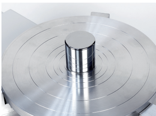
Pozycjonery na szalce susceptometru ułatwiają precyzyjne centrowanie wzorca masy.
