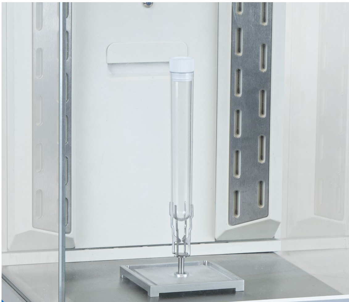
Dedykowany uchwyt do kolb i mikronaczynek zastosowany w mikrowadze XA 5Y.M.A
