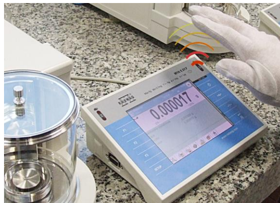
Rys. 35. Czujniki zbliżeniowe mikrowagi
