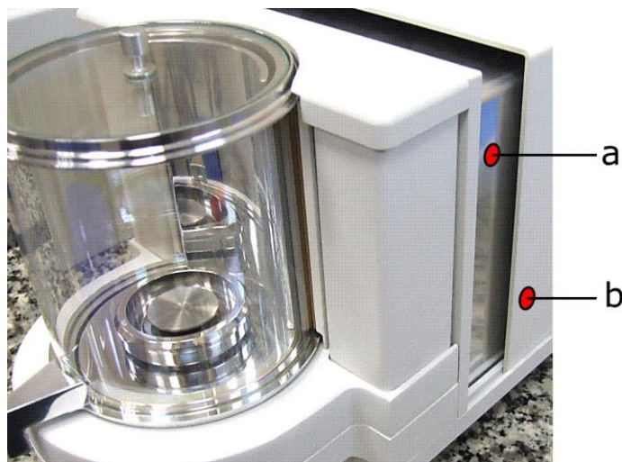
Rys. 5. Konstrukcja mikrowagi, osłona zewnętrzna (b) i wewnętrzna (a) modułu wagowego
