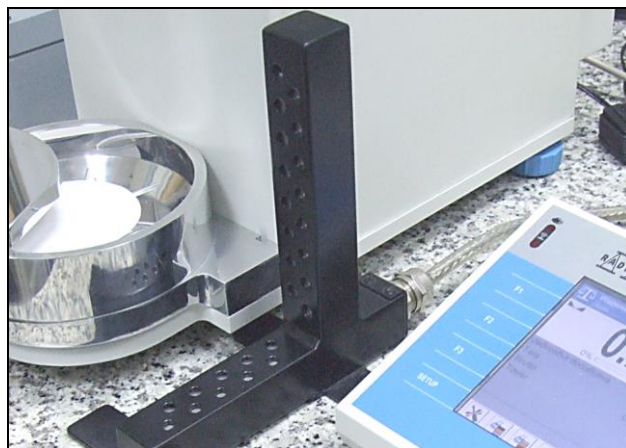
Rys. 30. Mikrowaga serii /F (do ważenie filtrów) z jonizatorem
