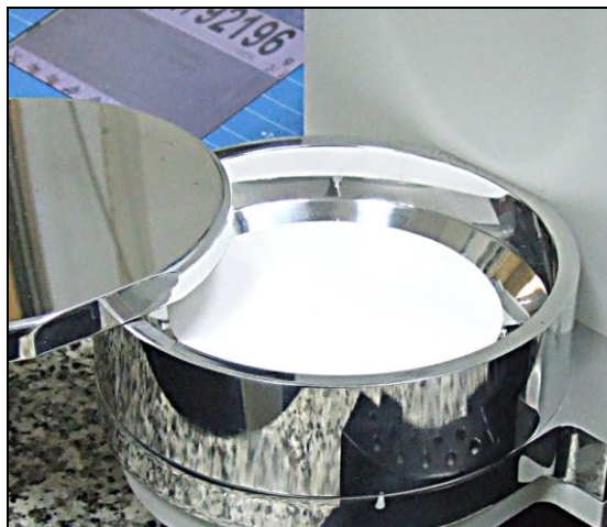
Rys. 14. MYA 5.3Y/F - Filtr celulozowy o średnicy 90 mm
