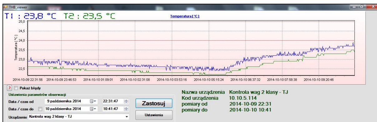
Rys. 8. Wykres zmian temperatury w cyklu dobowym, widoczny wzrost temperatury od godziny 6:00 jest spowodowany obecnością personelu
