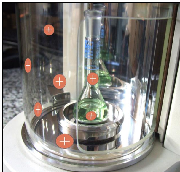
Rys. 16. Niezrównoważone ładunki elektrostatyczne
