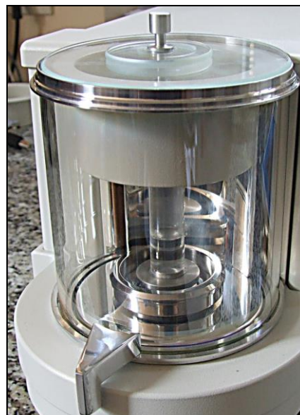
Rys. 32. Ważenie cieczy z wykorzystaniem tzw. pułapki parowej, aplikacja dla sprawdzania pipet tłokowych metodą wagową
