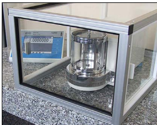
Rys. 15. Mikrowaga z osłoną przeciwpodmuchową
