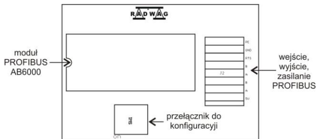
Usytuowanie modułu PROFIBUS na płycie 385Rxxxx (wer.A)
