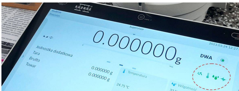
Rysunek 4. Kontrola warunków środowiskowych – mikrowaga MYA 5.5Y
