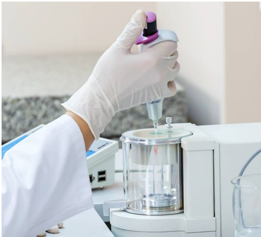
Rysunek 34. Kontrola objętości pipet tłokowych
