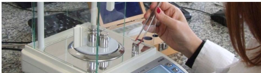
Rysunek 11. Kontrola czułości wagi wzorcami masy – QC Radwag
