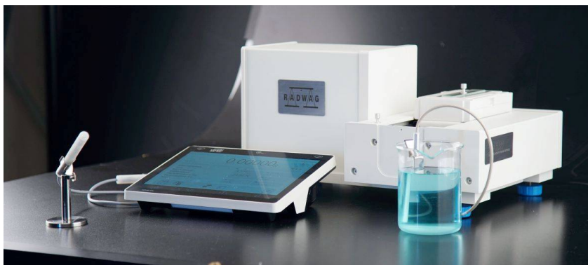
Rysunek 14. AP 12.5Y - kontrola objętości pipet tłokowych w trybie automatycznym
