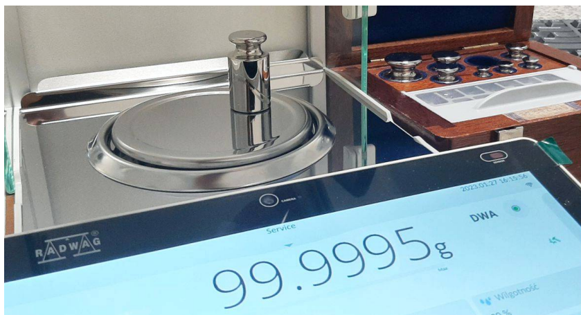
Rysunek 28. Test centryczności wagi XA 220.5Y
