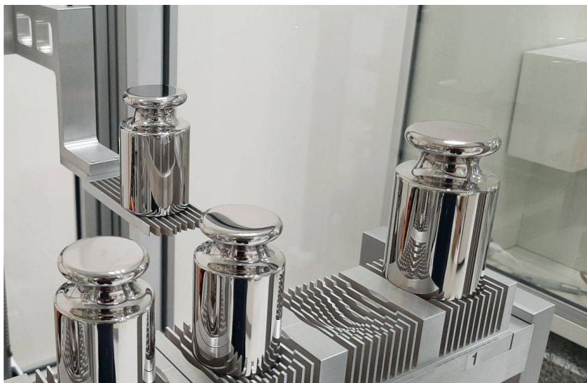
Rysunek 44. Badanie wzorców masy w cyklu automatycznym
