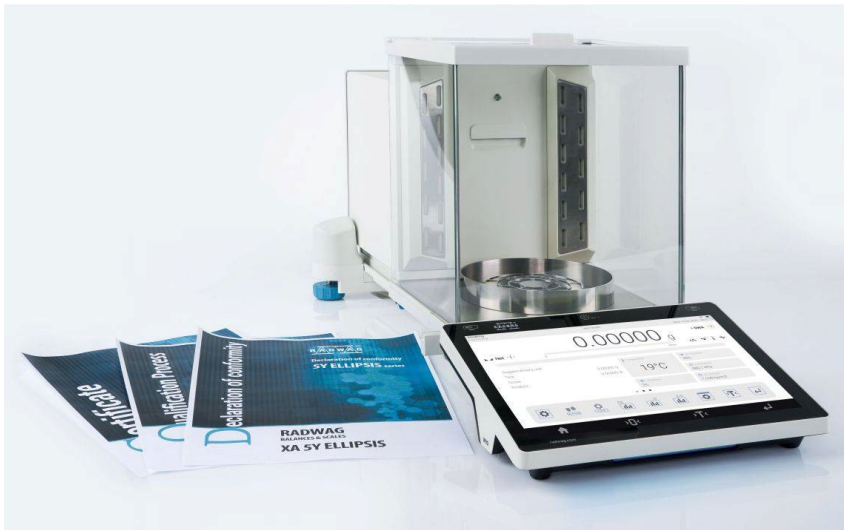
Figure 6. Balance analytique XA 82/220.5Y - documentation métrologique
