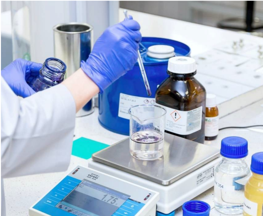
Figure 32. Le dosage des ingrédients lors de la production de peinture
