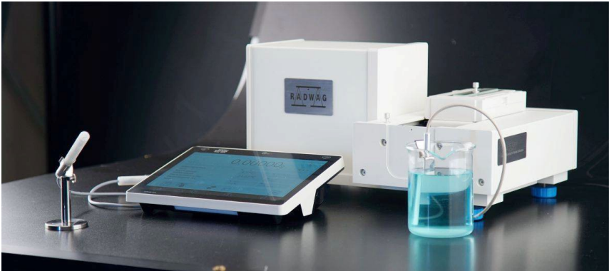
Figure 14. AP 12.5Y - le contrôle du volume des pipettes à piston en mode automatique
