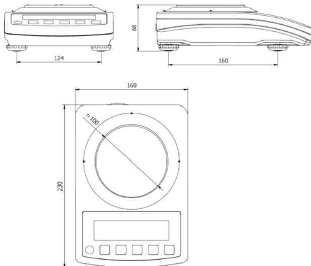
Figura 1. Dimensiones de la balanza WTC 200.
