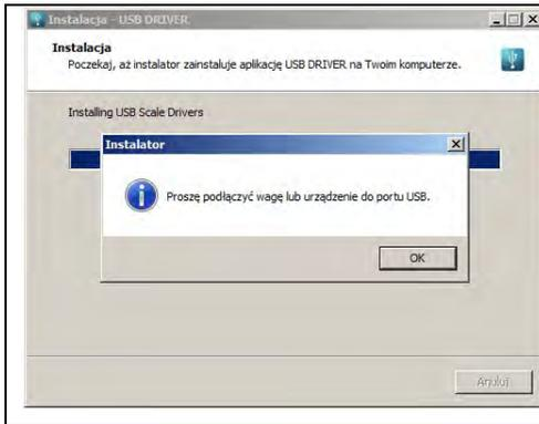
Conecte la balanza a un ordenador mediante un cable USB A / B no superado 1,8 metros (si la balanza ha sido conectada anterior al ordenador, desconecte y vuelva a conectar el cable USB). Presione la tecla **OK** para confirmar.
