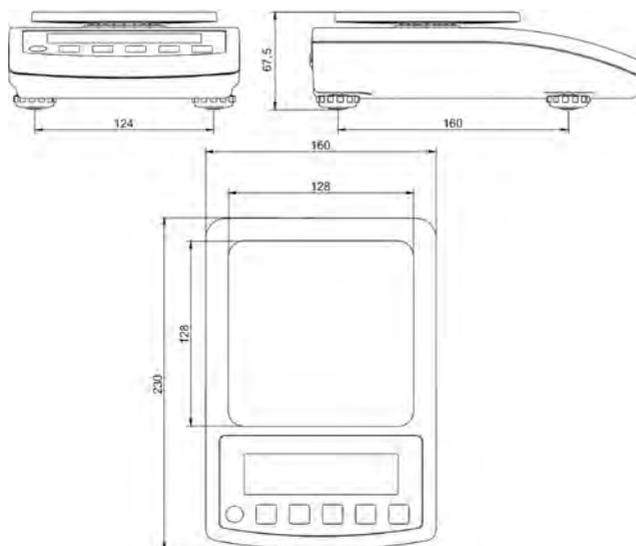
Figura 2. Dimensiones de la balanza WTC 600, WTC 2000 WTC 3000.
