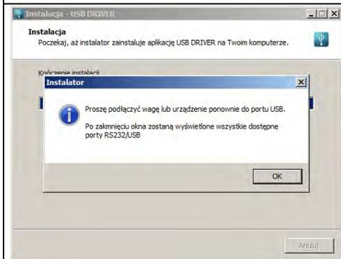
Volver a conectar la balanza al ordenador mediante un cable USB A / B ,no más de 1,8 m de longitud. Presione la tecla **OK** para confirmar.
