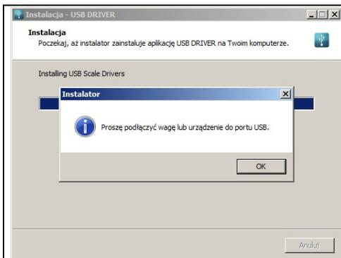
Conecte la balanza a un ordenador mediante un cable USB A / B no superado 1,8 metros (si la balanza ha sido conectada anterior al ordenador, desconecte y vuelva a conectar el cable USB). Presione la tecla **OK** para confirmar.
