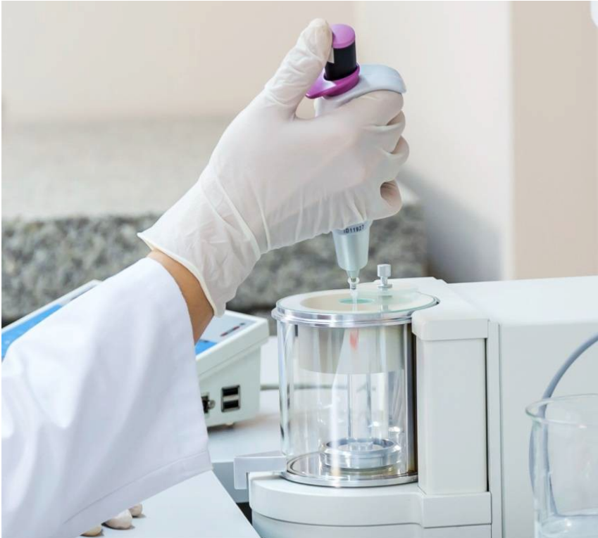
Figura 34. Control de volumen de pipetas de pistón.
