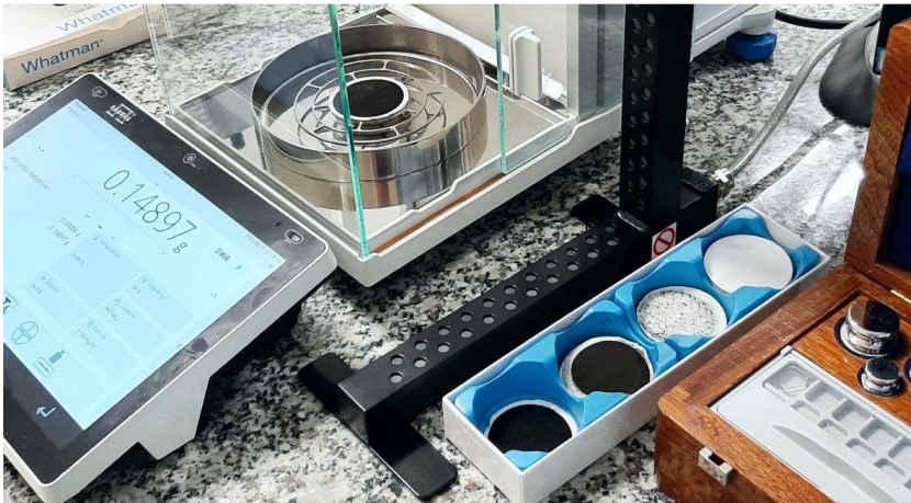
Figura 15. Electricidad estática en la medición de la masa de los filtros: ionizador DJ-04.
