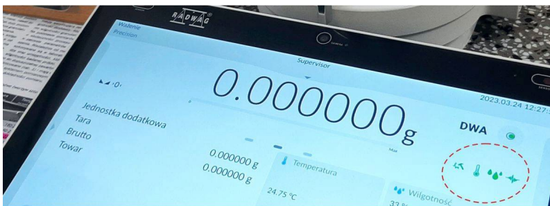
Figura 4. Control de condiciones ambientales: microbalanza MYA 5.5Y
