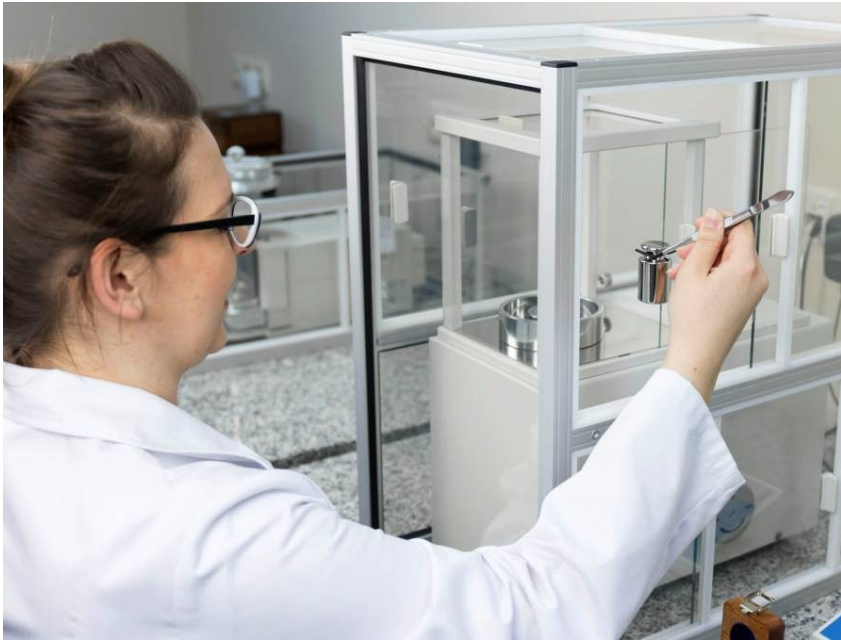
Figura 21. Comparador de la serie WAX: determinación de masa de la pesa.
