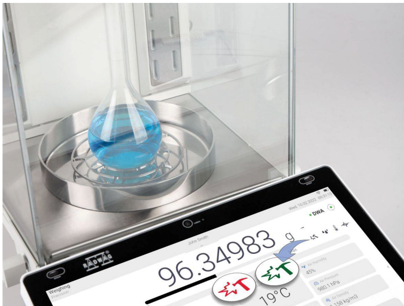
Figura 24. Evaluación automática de la calidad del proceso de pesaje.
