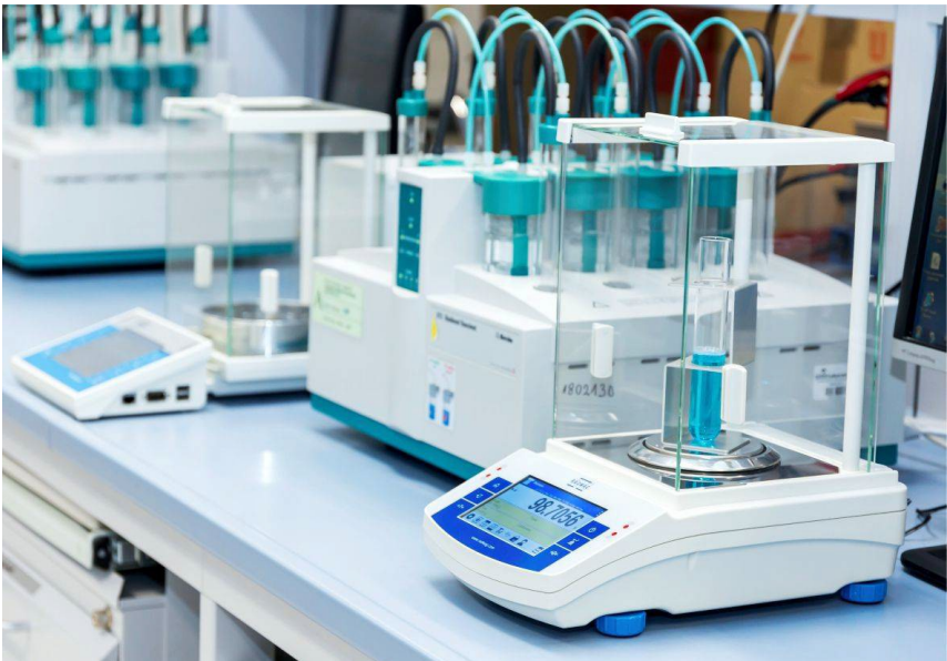
Figura 9. Balanza AS 220.X2: medición de la masa del líquido.
