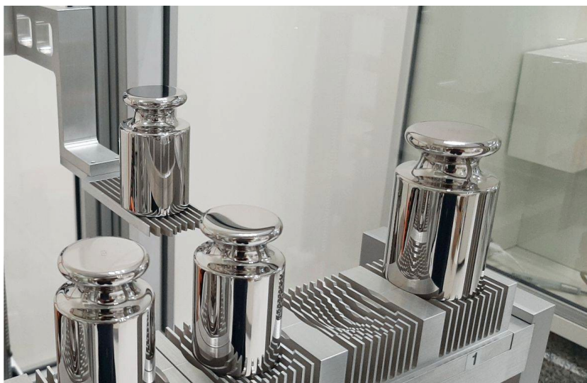
Figura 44. Prueba de patrones de masa en modo automático.
