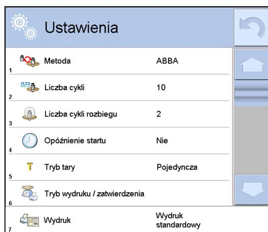
Para cambiar el tipo de método de calibración, presione el botón
