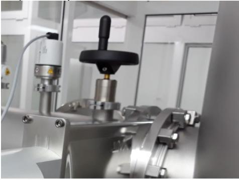
2. Al mirar a través de la trampilla de la cámara principal, el peso a cargar debe estar por encima de la posición 3 del cargador de patrones
