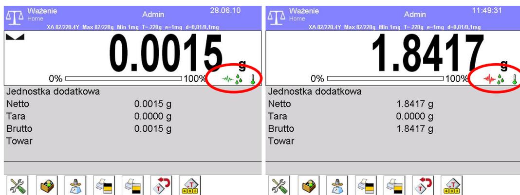
Las vibraciones se señalan mediante un pictograma respectivo que se muestra en la ventana de resultados de pesaje.
