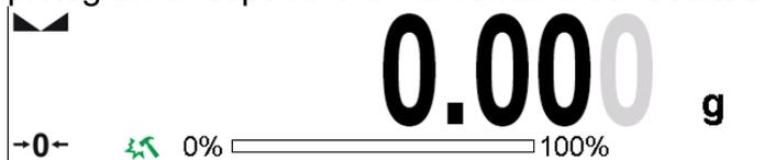
Si se detecta una carga incorrecta, el pictograma se vuelve rojo.
