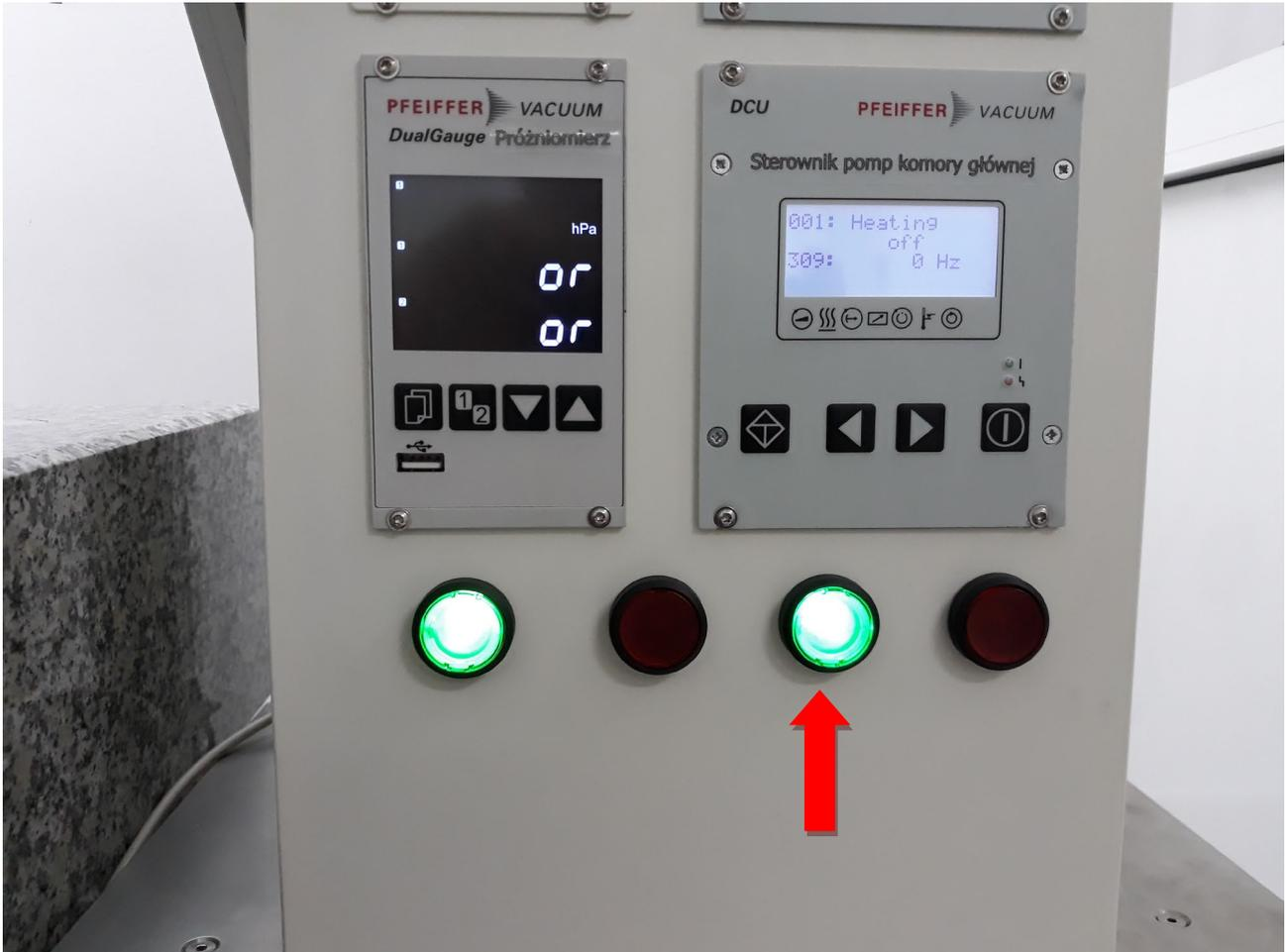
Al presionar el botón verde se abrirá la válvula solenoide que bombea aire a la cámara principal con un "clic" bastante característico, después de lo cual escuchará el silbido del aire en la cámara.
