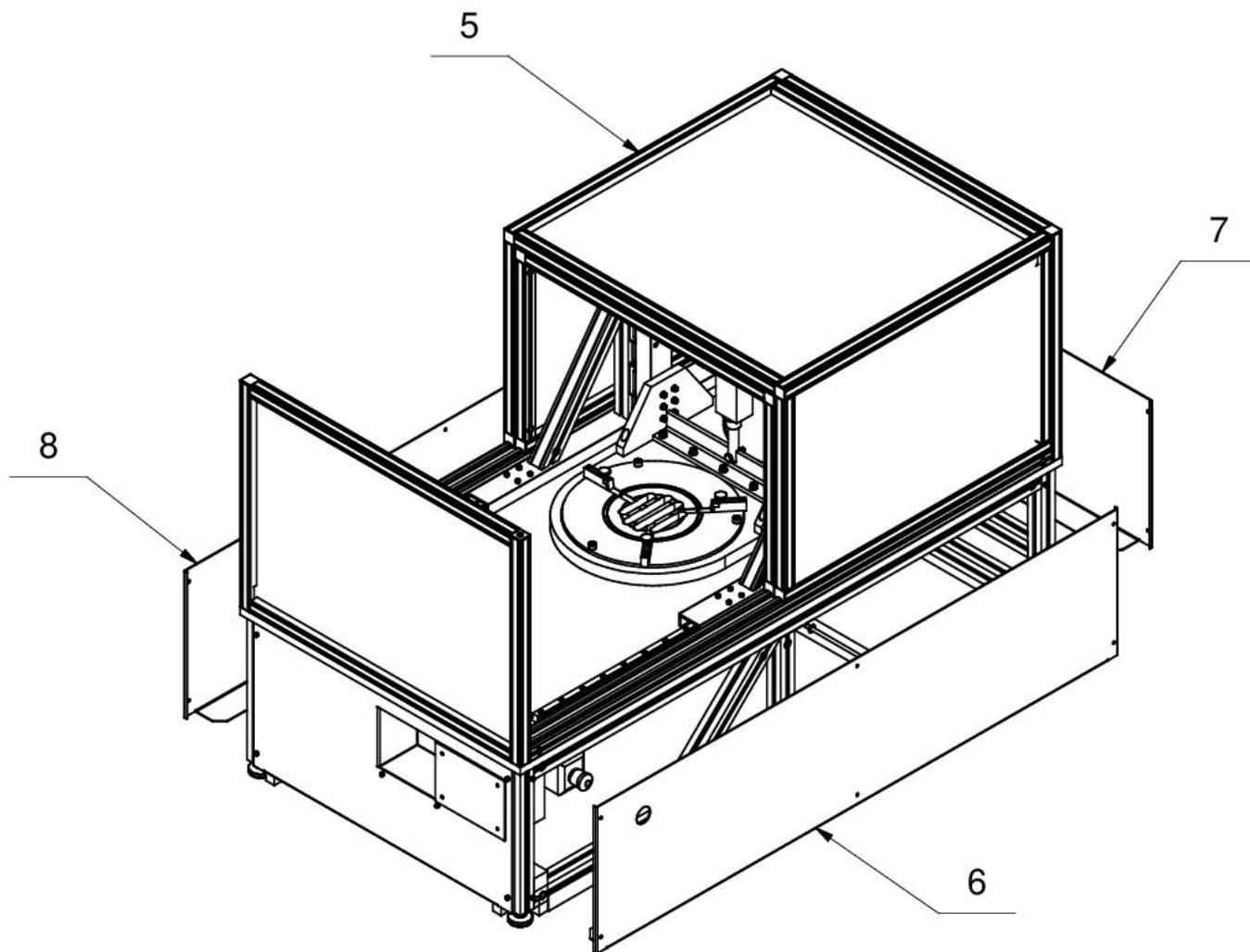
1.4 Coloque el robot comparador (5) en la piedra con el comparador.
