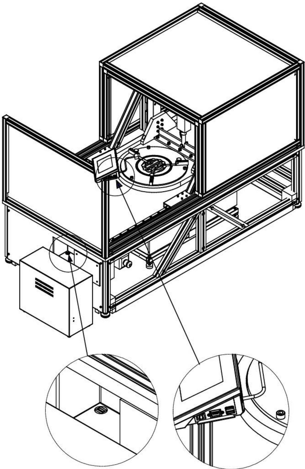
1.10 Conectar el robot del comporador (5) con el comporador (4).
