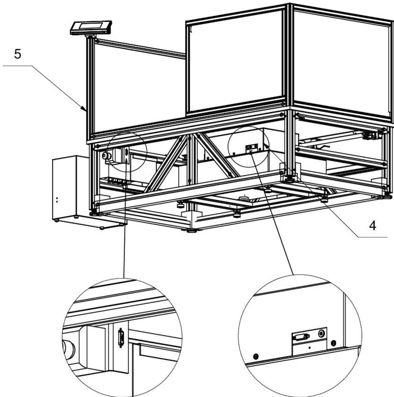
1.11 Conectar la caja de control(13) con el robot del comporador (5).
