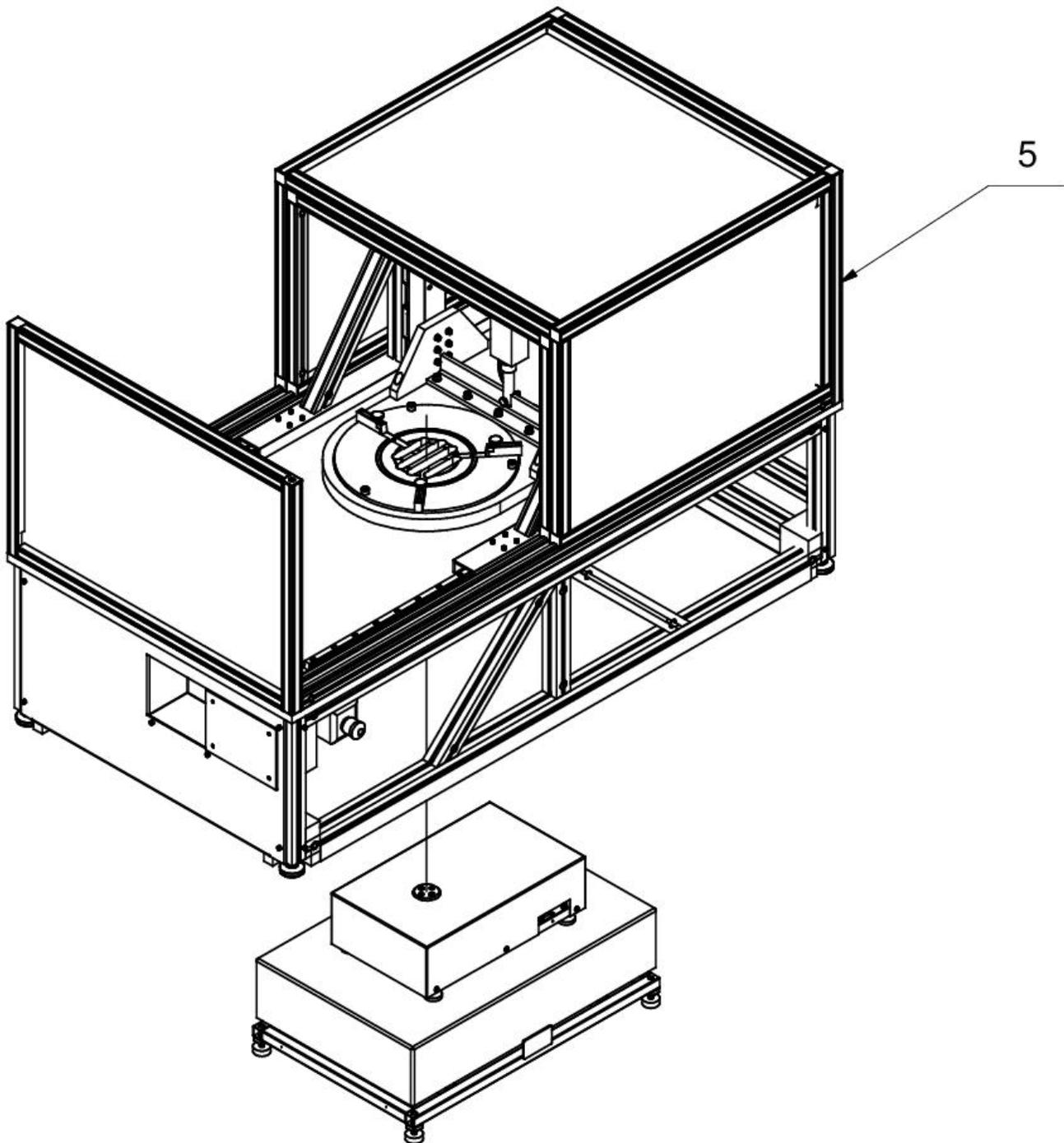
1.5 Desenrosque los tornillos (9) y retire el soporte del platillo (10). Coloque el comparador (4) en relación con el robot comparador (5) de modo que el orificio del soporte de pesas (11) esté centrado en relación con el anillo del platillo de pesaje (12) del comparador.
