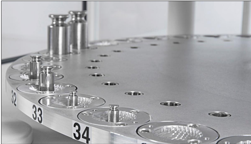
UMA 100 mass comparator, d=0.001 mg
