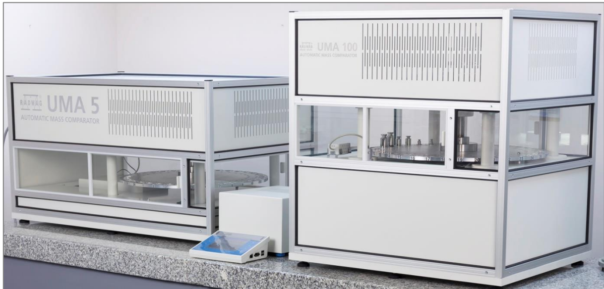
UMA automatic mass comparators, d=0,1 \mu\text{g} or d=1 \mu\text{g}
