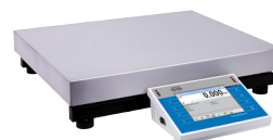
WLY C2/R głowica przy platformie
