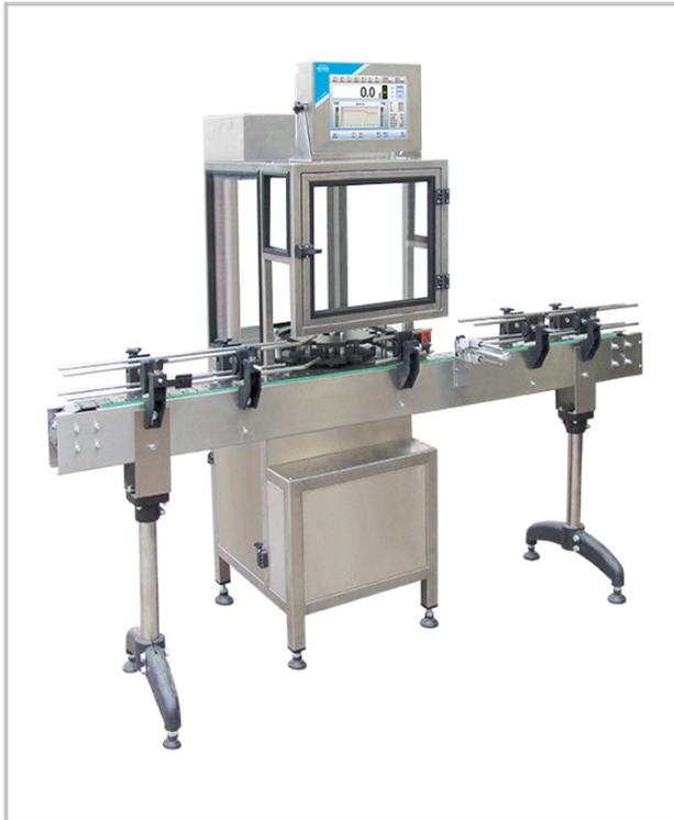
La balance automatique rotative DWR/H est conçue pour le travail en lignes technologiques aidant à produire des marchandises qui sont placées dans les récipients cylindriques, p.ex. : aérosols, vaporisiers, bouteilles en verre, bouteilles en plastique, etc.
