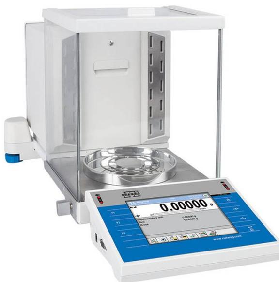
Fig. 9. Analytical balance XA 52 4Y.A PLUS
