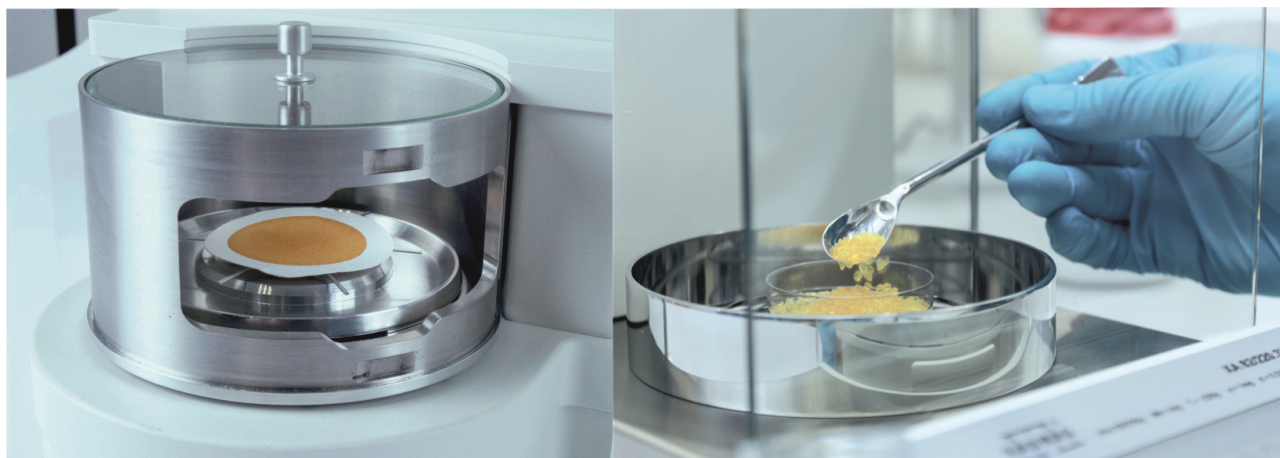
Rysunek 18. Mikrowaga MYA 2.4Y.F.A PLUS – pomiar masy filtra, XA 82/220.4Y – ważenie proszków
