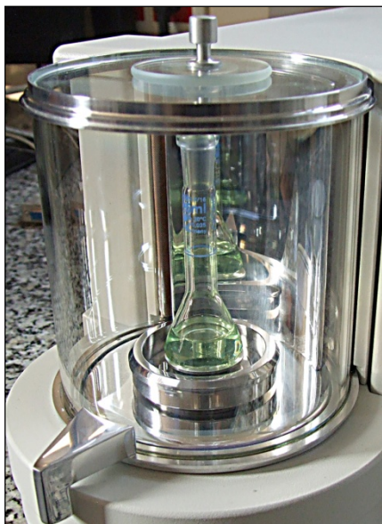
Rysunek 41. Ważenie cieczy z wykorzystaniem naczynia o zwężającym się wlocie, ograniczenie parowania cieczy w trakcie ważenia
