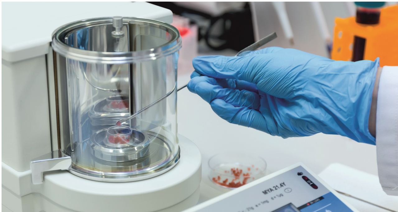
Rysunek 10. Mikrowaga – ważenie proszków
