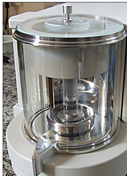
Rysunek 42. Ważenie cieczy z wykorzystaniem tzw. pułapki parowej, aplikacja dla sprawdzania pipet tłokowych metodą wagową
