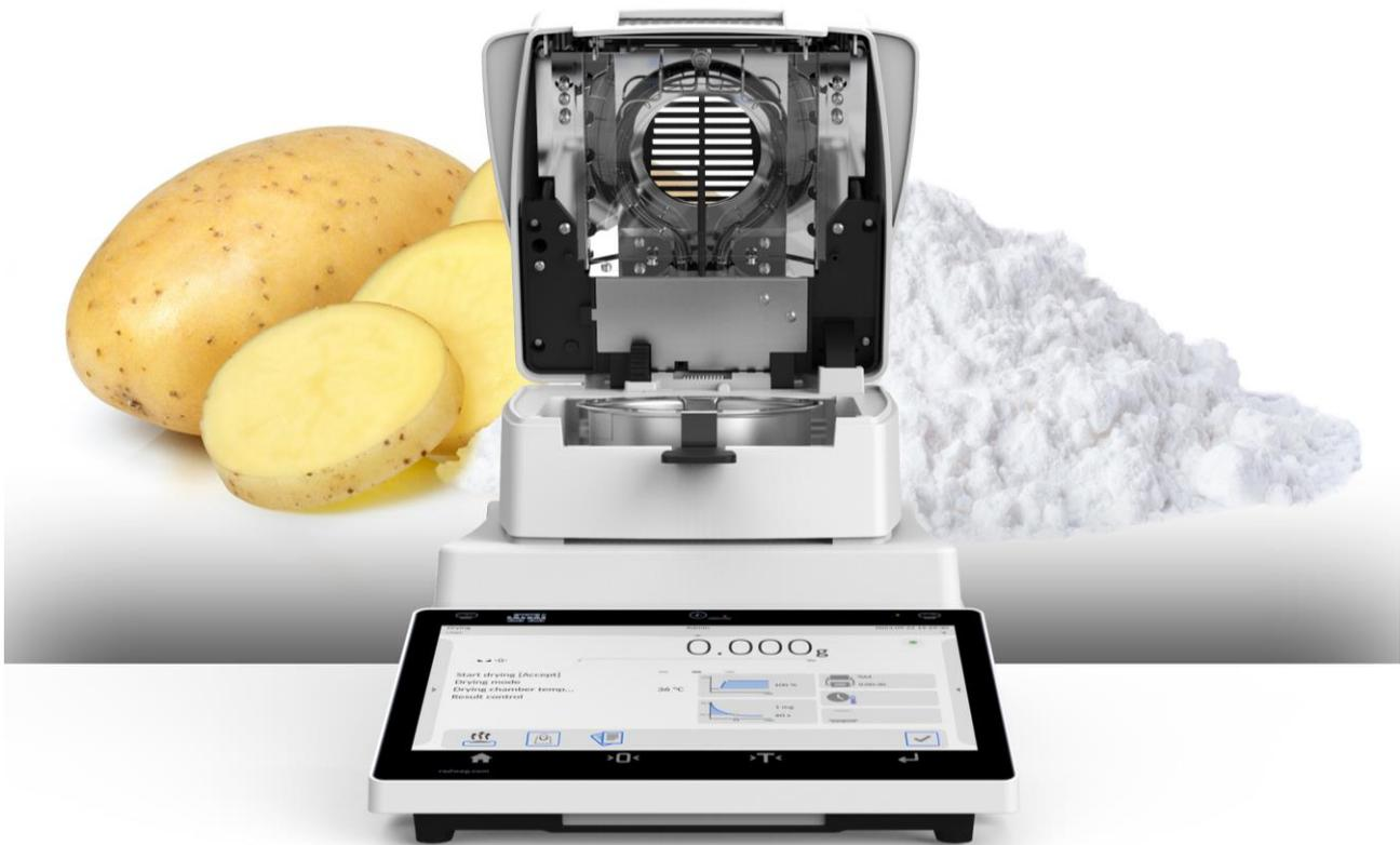
Das White Paper enthält grundlegende Informationen für die Validation des Trocknungsverfahrens für Produkte wie Kartoffelstärke unter Verwendung von Feuchtebestimmern der Serien MA R, MA X2, MA X7 und MA 5Y von Radwag Elektronische Waagen. Das White Paper kann als Grundlage für die Entwicklung einer eigenen Trocknungsmethode unter Berücksichtigung der spezifischen Eigenschaften des getesteten Produktes verwendet werden.
