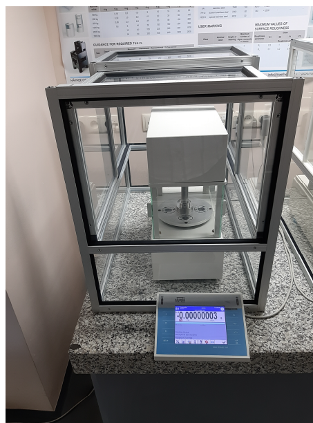
Rys. 8. Pierwszy na świecie automatyczny nano komparator masy (NANO.AK-4/500N, RADWAG) https://radwag.com/pl/automatyczny-nano-komparator-masy-nano-ak-4-500,w1,R6X,110-106#1
