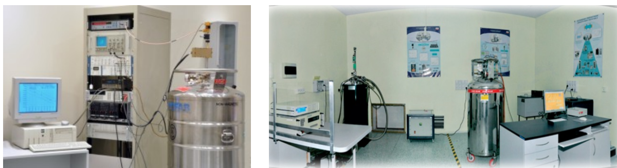
Rys. 5. Państwowe wzorce jednostki miary stałego napięcia elektrycznego (zdjęcie lewe: złącza Josepsona z instalacją kriogeniczną) oraz rezystancji (zdjęcia prawe: układ kriogeniczny do realizacji kwantowego efektu Halla) funkcjonujące w Głównym Urzędzie Miar w Warszawie od, odpowiednio, 2003 i 2016 roku. ( www.gum.gov.pl )
