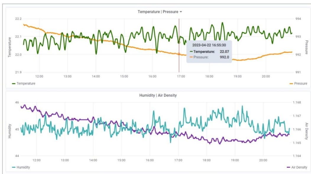
Rysunek 4. Rejestracja i wizualizacja parametrów środowiskowych podczas komparacji (22.04.2023)
