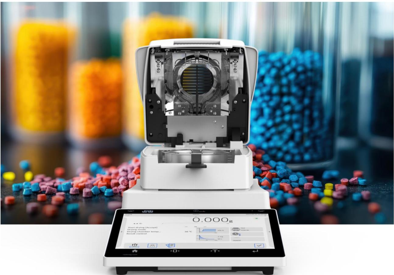
La nota de aplicación contiene información básica para el proceso de validación del método de secado de gránulos de plástico utilizando analizadores de humedad de las series MA R, MA X2, MA X7 y MA 5Y fabricados por Radwag. La nota de aplicación puede ser la base para desarrollar su propia metodología de secado, teniendo en cuenta las características específicas del producto probado.
