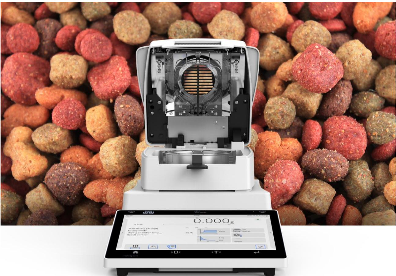
La nota de aplicación contiene información básica para el proceso de validación del método de secado para productos de tipo comida para perros utilizando analizadores de humedad de las series MA R, MA X2, MA X7 y MA 5Y fabricados por Radwag. La nota de aplicación puede ser la base para desarrollar su propia metodología de secado, teniendo en cuenta las características específicas del producto probado.
