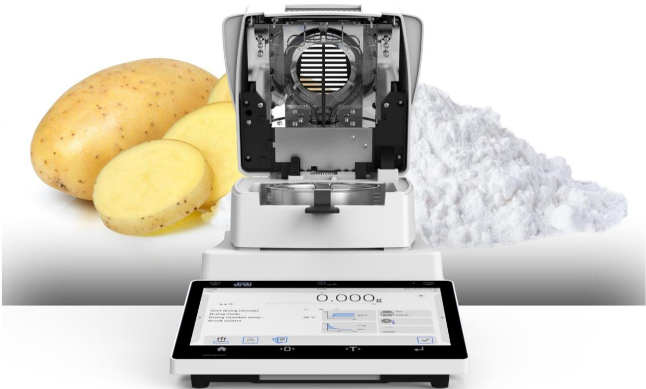
La nota de aplicación contiene información básica relacionada con la validación del método de secado el almidón de patata utilizando analizadores de humedad de las series MA R, MA X2, MA X7 y MA 5Y fabricados por Radwag. La nota de aplicación puede ser la base para desarrollar su propia metodología de secado, teniendo en cuenta las características específicas del producto probado.
