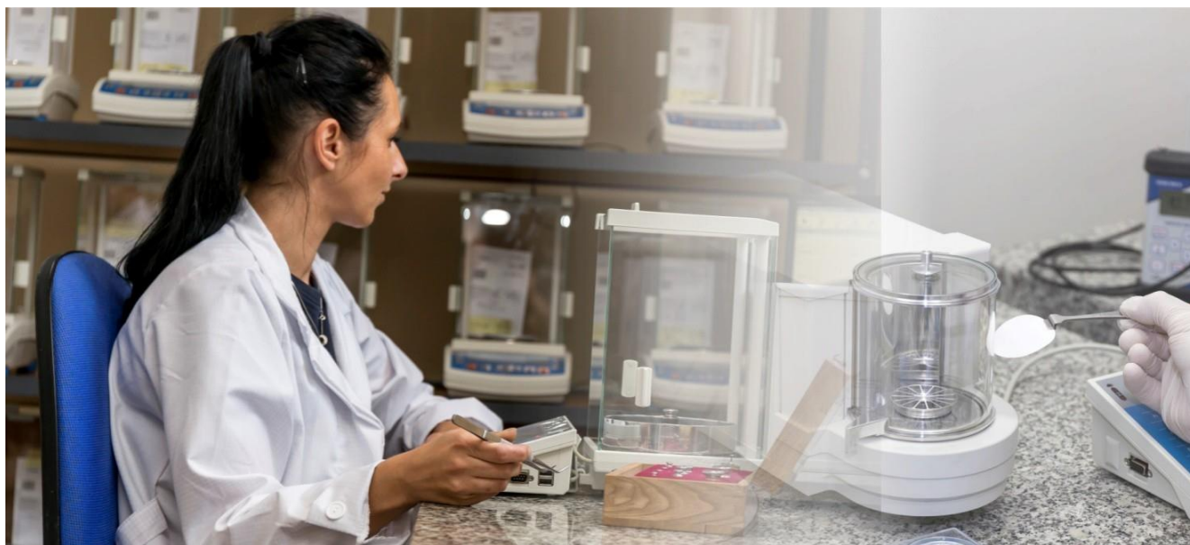
Figura 13. Control metrológico de la balanza, medición de la masa del filtro
