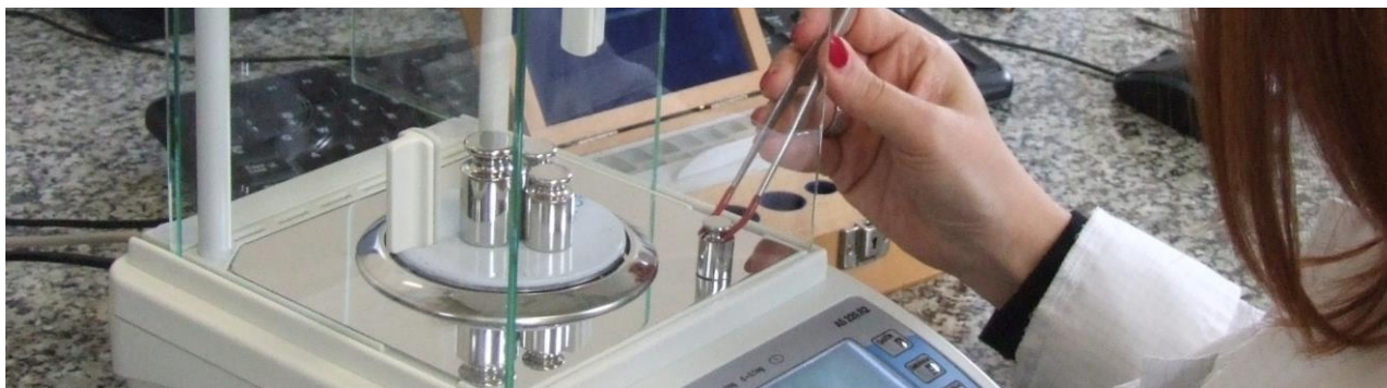
Figura 1. Departamento de Control de Calidad – Balanza AS 220.R2, evaluación del valor correcto AS 220.R2, carga máxima 220 g, unidad de lectura elemental d = 0,1 \text{ mg} , ajuste automático, certificado OIML
