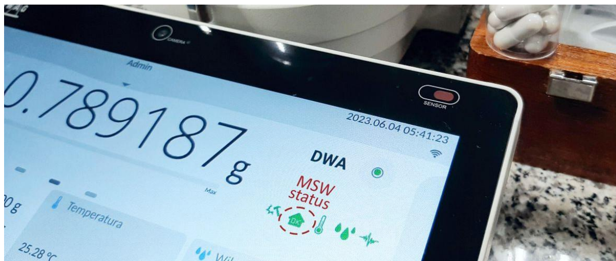
Figura 9. Microbalanza MYA 5.5Y con función MSW activa MYA 5.5Y, carga máxima 5 g, división de lectura elemental d = 0,001 mg, Ajuste interno, certificado OIML
