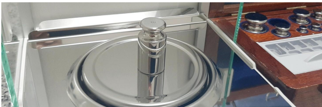
Figura 6. Control de la desviación de la sensibilidad de la balanza mediante un patrón de masa
