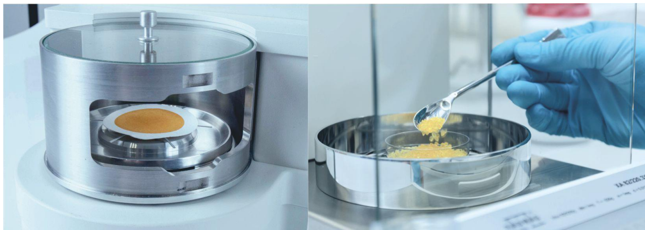
Figura 8. Prueba de cambios de masa del filtro después de la filtración, medición de la cantidad de sustancia
