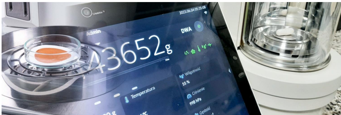
Figura 11. Balanza XA 82/220.5Y, medición de masa de filtros, Microbalanza MYA 2.5Y, medición de masa de cápsulas - uniformidad de masa de preparación médica (USP).
