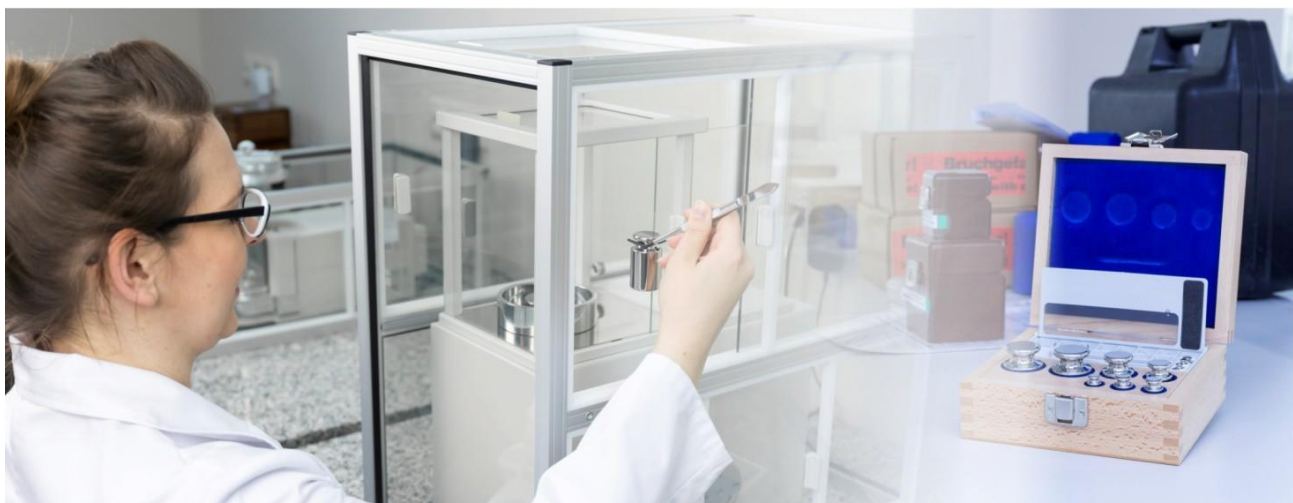
Figura 2. Calibración del comparador de masa mediante método manual
