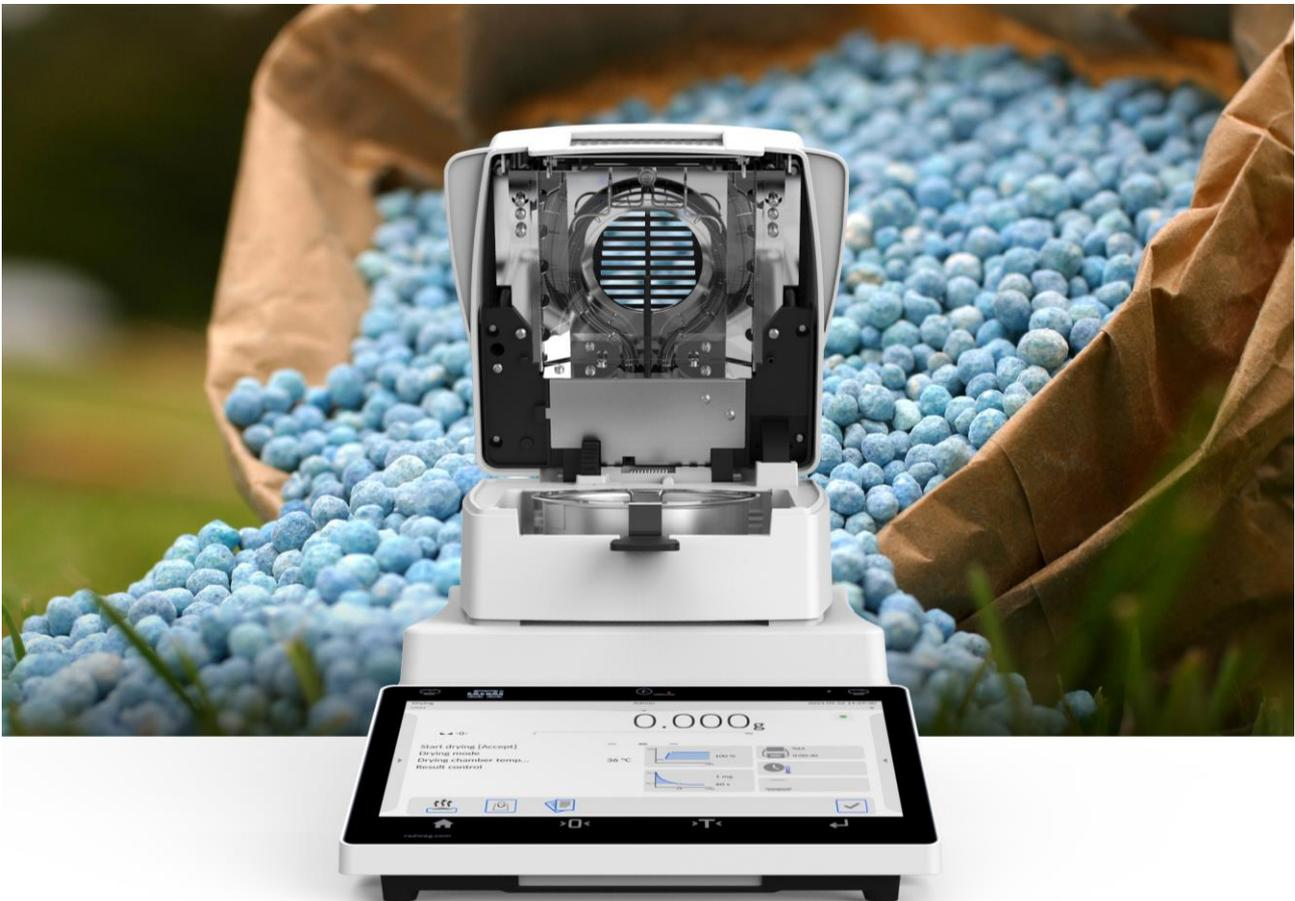
Das White Paper enthält grundlegende Informationen zur Validierung des Trocknungsprozesses von künstlichen Düngemitteln unter Verwendung von Feuchtebestimmern der Serien MA R, MA X2, MA X7 und MA 5Y von Radwag. Das White Paper kann als Grundlage für die Entwicklung einer eigenen Trocknungsmethode unter Berücksichtigung der spezifischen Eigenschaften des getesteten Produktes verwendet werden.
