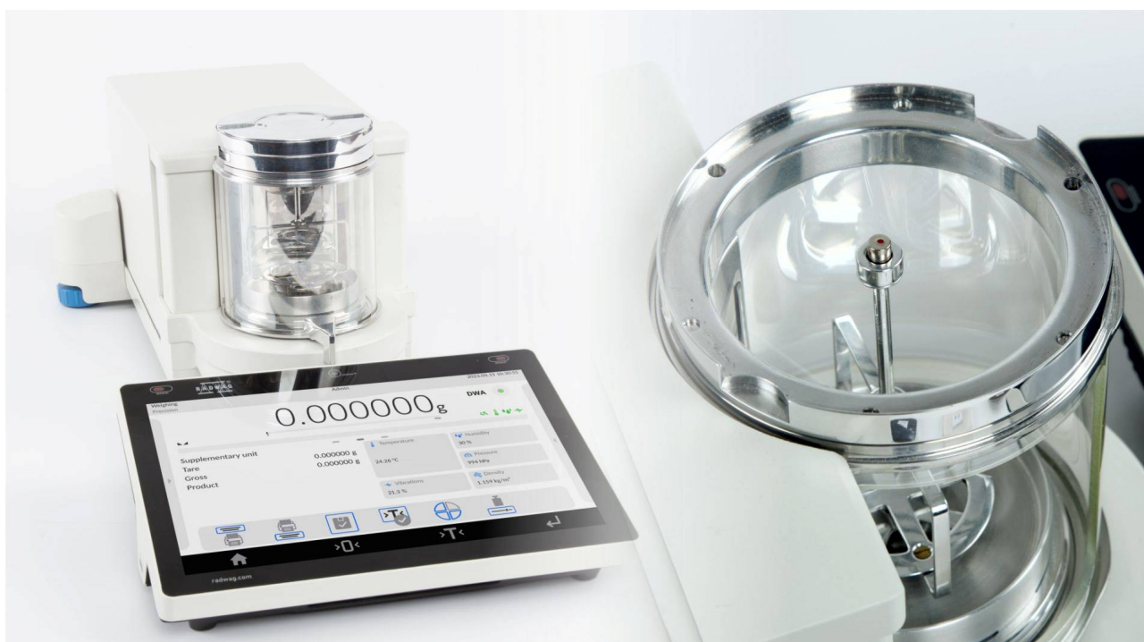
Rysunek 43. Mikrowaga MYA 5.5Y – pomiar podatności magnetycznej
