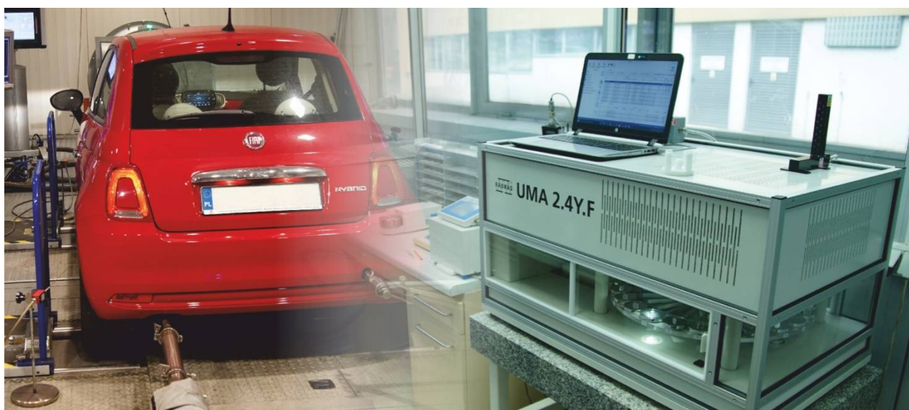
Rysunek 30. Hamownia podwoziowa oraz układ automatyczny do pomiaru masy filtrów.
