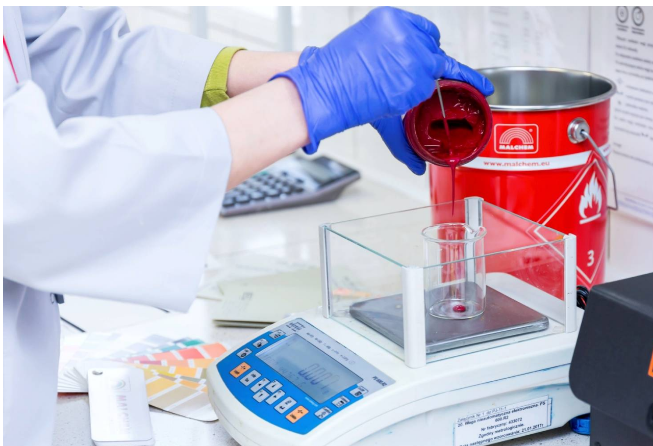
Rysunek 10. Waga PS 1000.R2 – pomiar masy farb i lakierów
