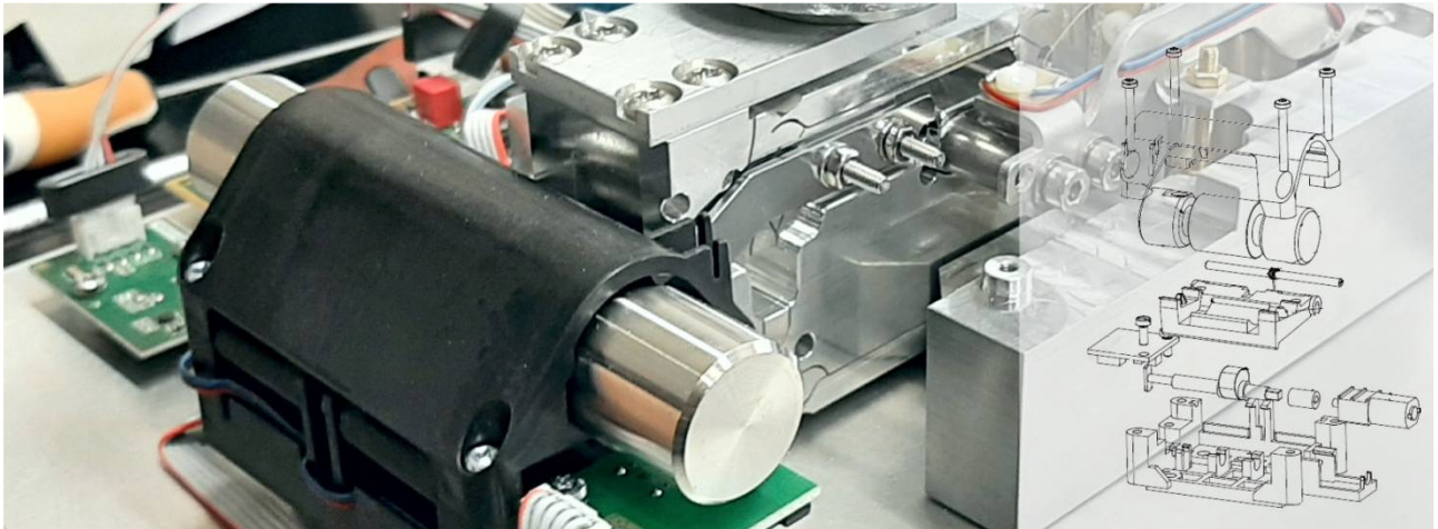
Rysunek 47. Mechanizm adiustacji wag serii PS w wadze z monolitycznym układem pomiarowym
