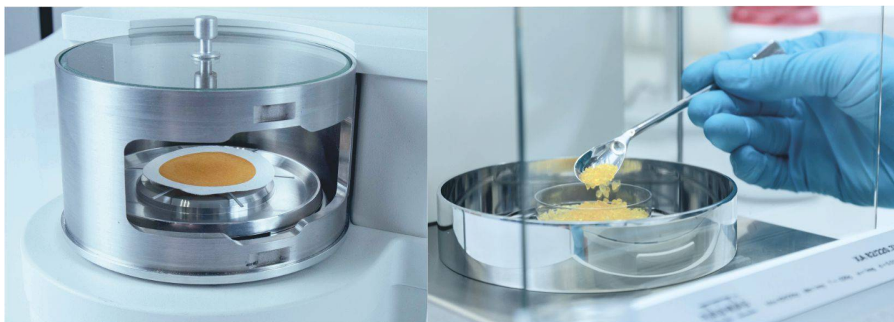
Rysunek 13. Badanie zmian masy filtra po procesie sączenia (oczyszczalnia ścieków), odmierzanie ilości substancji (farmacja)
