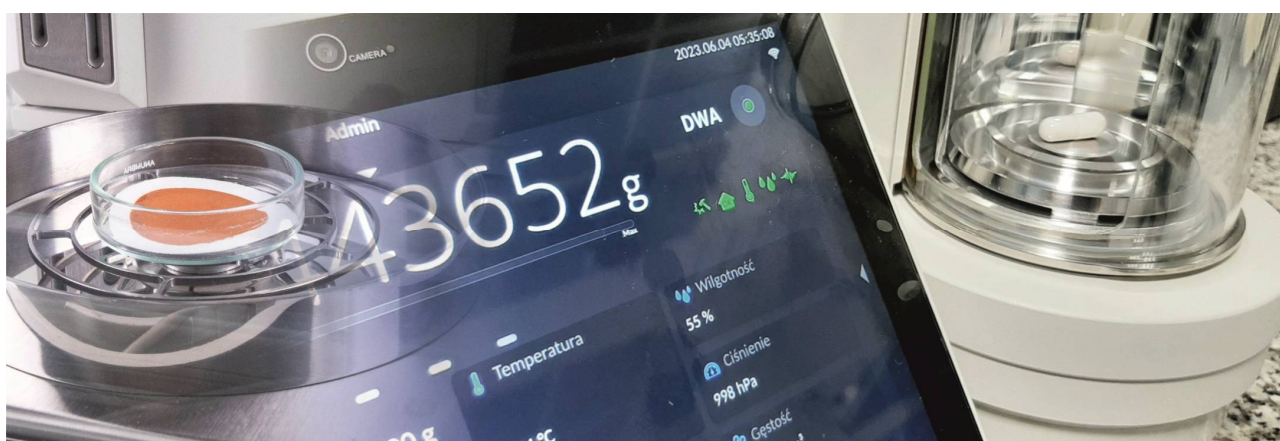
Rysunek 22. Waga XA 82/220.5Y, pomiar masy filtra, Mikrowaga MYA 2.5Y, pomiar masy kapsułki – jednolitość masy preparatów medycznych (USP)
