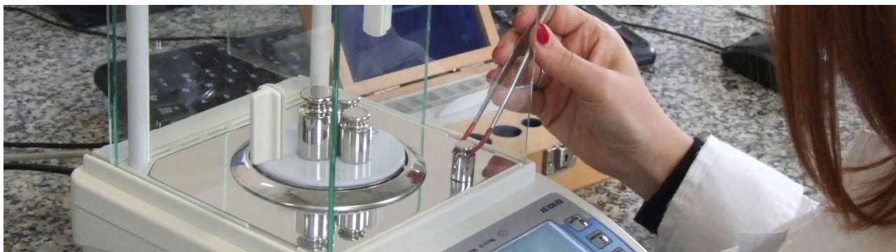
Rysunek 11. Dział Kontroli Jakości – waga AS 220.R2, ocena poprawności wskazań AS 220.R2, Obciążenie maksymalne 220g, działka elementarna d=0.1mg adiustacja automatyczna, certyfikat OIML
