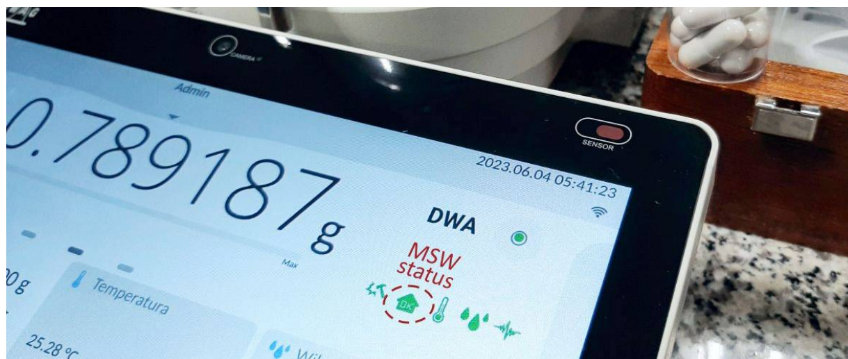
Rysunek 14. Mikrowaga MYA 5.5Y z aktywną Funkcją MSW MYA 5.5Y, Obciążenie maksymalne 5g, działka elementarna d=0.001mg Adiustacja wewnętrzna, certyfikat OIML
