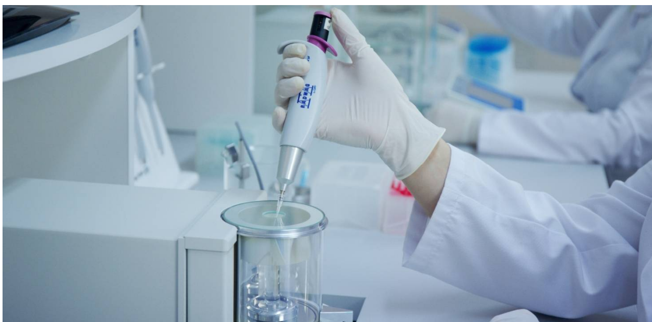
Rysunek 27. Kontrola objętości pipet jednokanałowych
