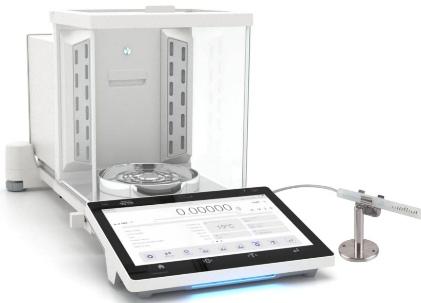
Rysunek 23. Waga XA 210.5Y.A z dodatkowym czujnikiem warunków środowiskowych
