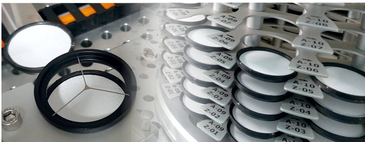
Rysunek 54. Układ automatyczny RB 2.5Y – wzorec masy oraz magazyn filtrów
