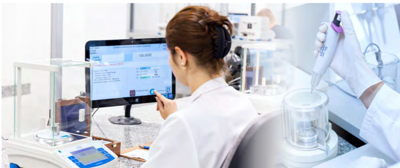
Rysunek 4. Weryfikacja zgodności z wymaganiami – Dział QC Radwag Kontrola parametrów metrologicznych wag laboratoryjnych wg. OIML R 76 Weryfikacja objętości pipet tłokowych metoda referencyjną ISO 8655-6:2022
