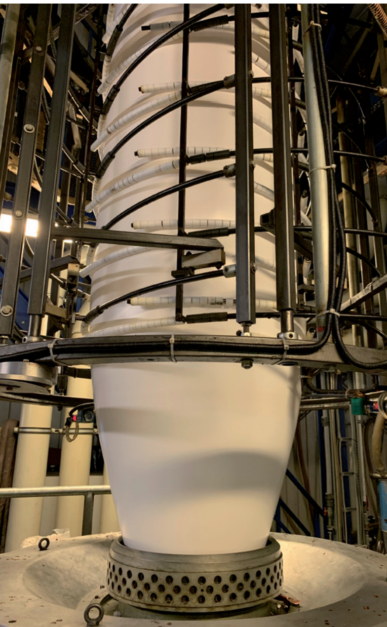
Proces rozdmuchu białej folii polietylenowej
