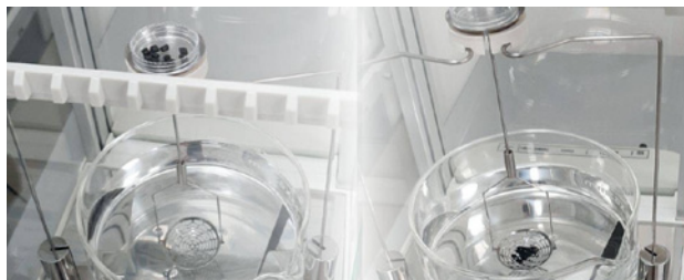
Rysunek 4. Badanie granulatu PA6 GF15 w wodzie destylowanej. Pomiar masy próbki w powietrzu oraz w cieczy na dolnej szalce zestawu
