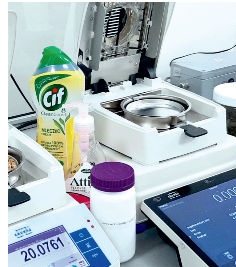
Rysunek 5. Wagosuszarki serii MA 50.X2 oraz MA 50/1.5Y w badaniach laboratoryjnych
