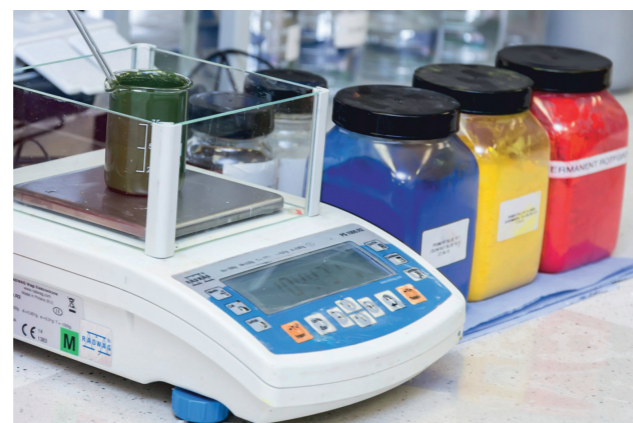
Rysunek 1. Waga PS 1000.R2 w procesie recepturowania składników
