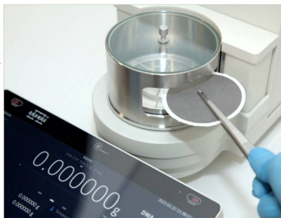
Rysunek 20. Korekta czułości wagi, Mikrowaga MYA 5.5Y.FA , Max 5g, działka elementarna d=1 \times 10^{-6} \text{g} , Precyzja pomiaru S=0,5 \times 10^{-6} \text{g} , adiustacja wewnętrzna automatyczna, OIML certyfikacja
