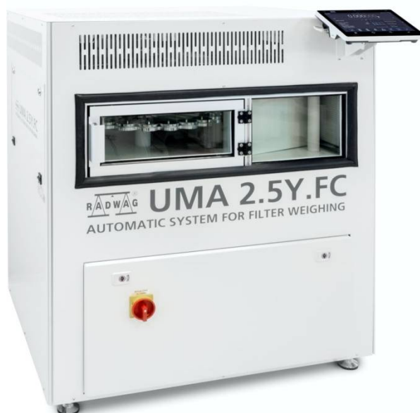
Rysunek 39. UMA 2.5Y.FC - System automatyczny do badania zmienności masy filtrów, Kondycjonowanie filtrów: stabilizacja wilgotności i temperatury, Maksymalne obciążenie 2g, działka elementarna d=1 \times 10^{-6} mg lub d=1 \times 10^{-7} g, Max ilość filtrów 24szt., Zgodność z PN-EN 12341:2024
