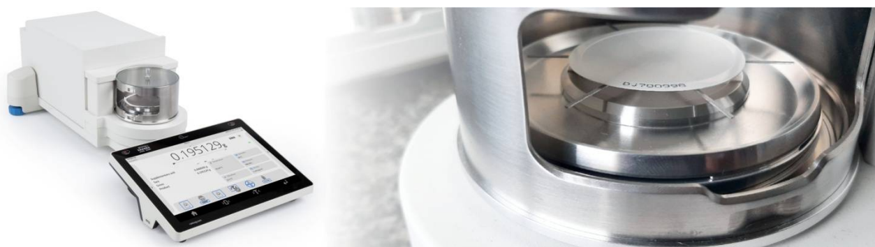
Rysunek 34. Mikrowaga MYA 5.5Y.FA, Max 5g, działka elementarna d=1 \times 10^{-6} \text{g} , Precyzja pomiaru S=0,5 \times 10^{-6} \text{g} , adiustacja wewnętrzna automatyczna, OIML certyfikacja, Pomiar filtrów o max średnicy \phi 70mm. Zgodność z PN-EN 12341:2024
