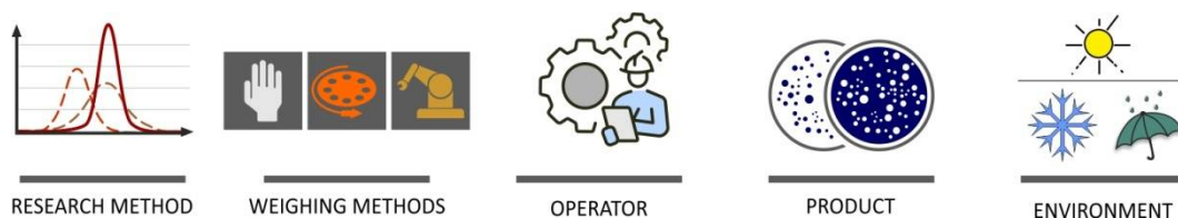
Rysunek 17. Czynniki wpływające na wartość błędu losowego w procesie pomiaru masy
