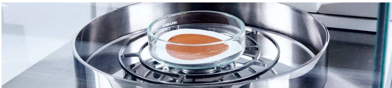
Rysunek 23. Pomiar masy sączka – badanie zawiesin, oczyszczalnia ścieków, waga XA 82/220.5Y Działka elementarna d=0.01/0.1\text{mg} , adjustacja automatyczna, certyfikat OIML
