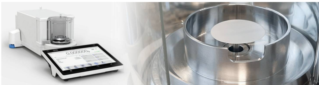
Rysunek 33. Mikrowaga MYA 5.5Y, Max 5g, działka elementarna d=1 \times 10^{-6} \text{g} , Precyzja pomiaru S=0,5 \times 10^{-6} \text{g} , adiustacja wewnętrzna automatyczna, OIML certyfikacja, Modyfikacja komory ważenia dla filtrów \phi 25mm. Zgodność z PN-EN 12341:2024
