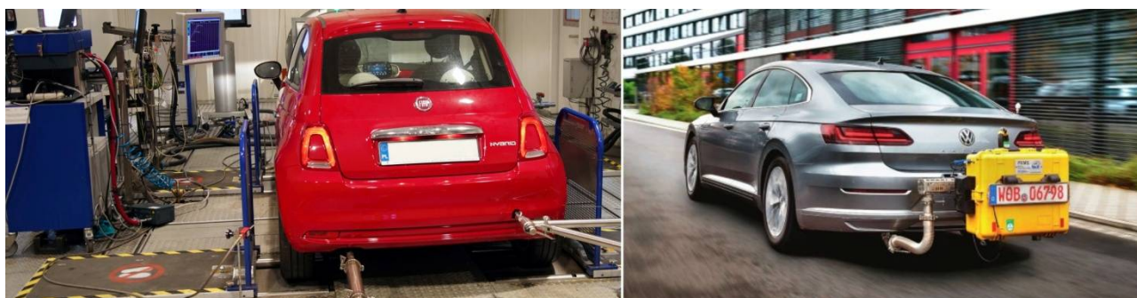
Rysunek 9. Badanie emisji cząstek stałych metodą WLTP oraz RDE
