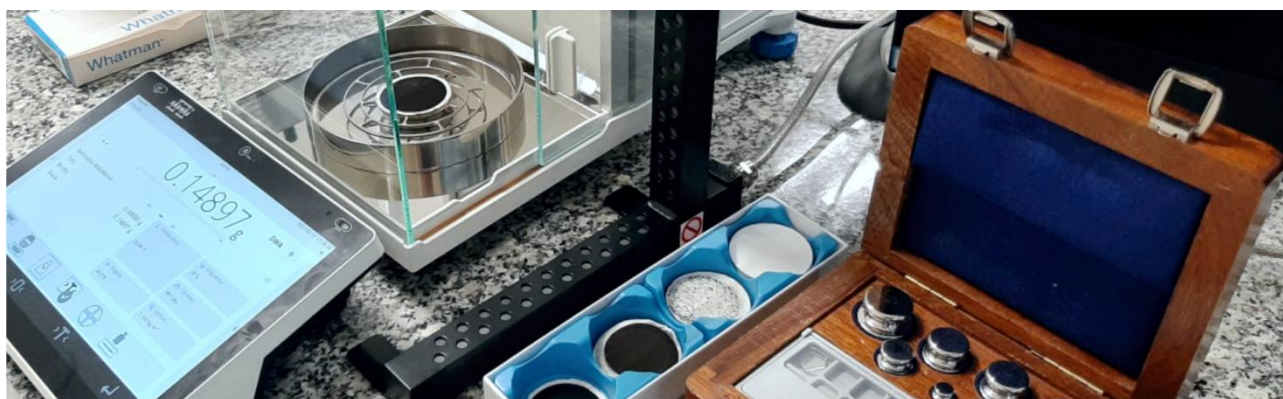
Rysunek 59. Pomiar masy filtrów – akcesoria w metodzie pomiarowej
