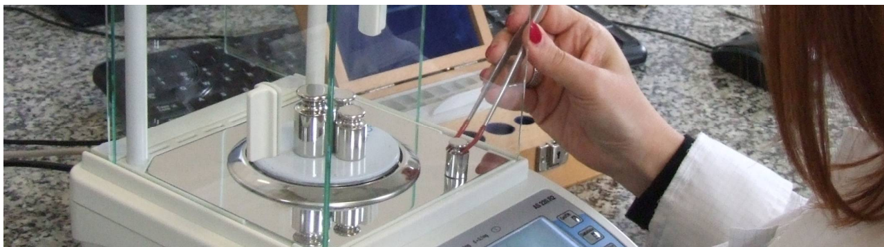
Rysunek 1. Kontrola parametrów metrologicznych wagi – dział QC firmy Radwag
