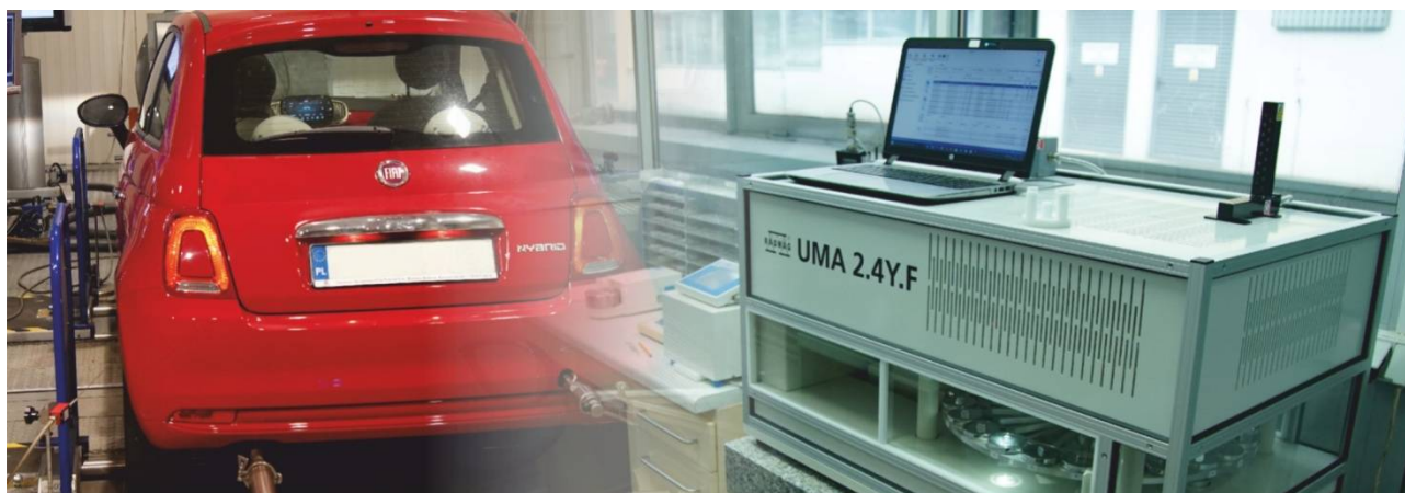
Rysunek 42. Układ pomiarowy UMA 2.4Y.F oraz widok hamowni podwoziowej
