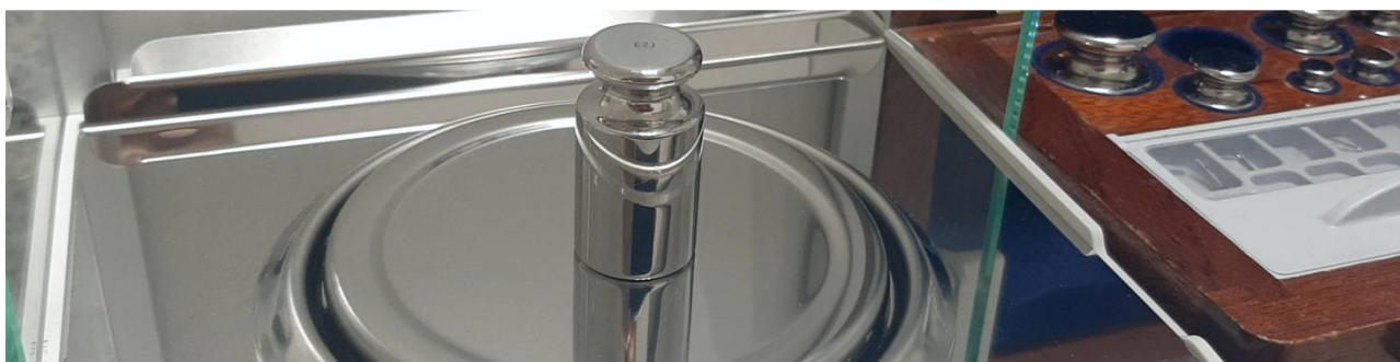
Rysunek 14. Adiustacja fabryczna z wykorzystaniem certyfikowanych wzorców
