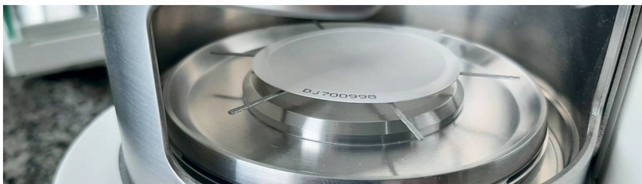
Rysunek 16. Manualny pomiar masy filtra – mikrowaga MYA 5.5Y, Max 5g, działka elementarna d=1 \times 10^{-6} \text{g} , Precyzja pomiaru S=0,5 \times 10^{-6} \text{g} , adiustacja wewnętrzna automatyczna, OIML certyfikacja
