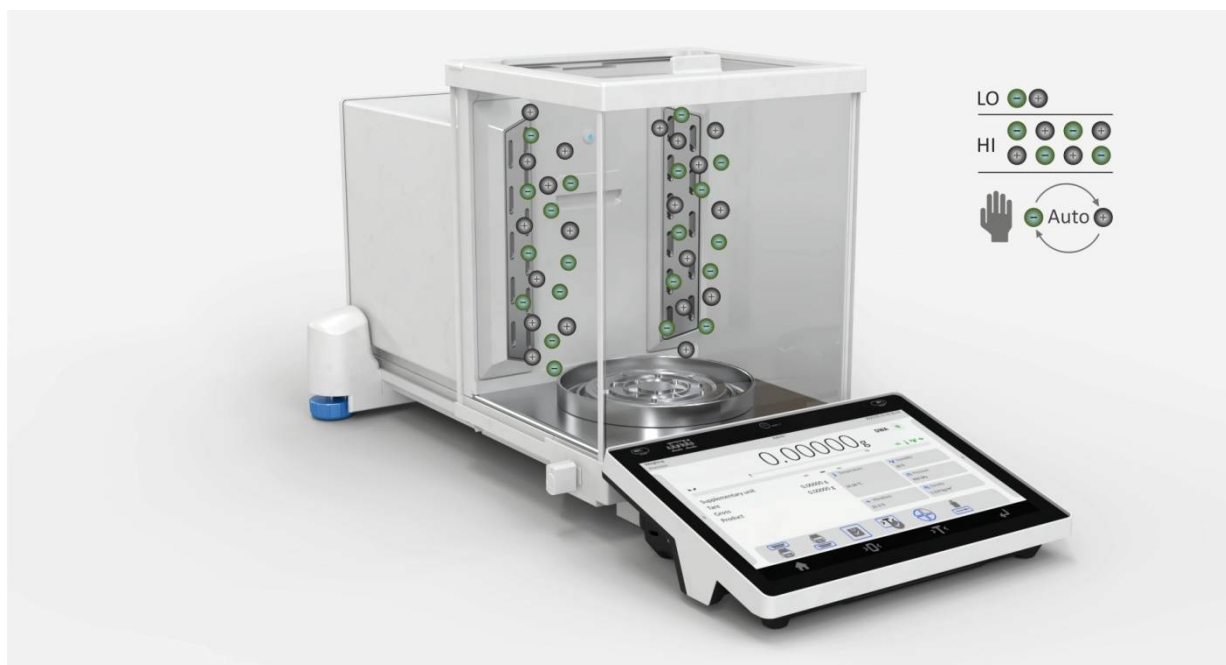
Rysunek 55. Waga XA 210.5Y.A - jonizator w konstrukcji wagi, Maksymalne obciążenie 210g, działka elementarna d=1 \times 10^{-5} \text{g} , Adiustacja wewnętrzna automatyczna, OIML certyfikacja. Zgodność z PN-EN 12341:2024
