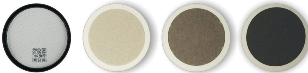
Rysunek 46. Widok filtra przed ekspozycją z kodem QR, filtr umieszczony w antystatycznej kasce oraz filtrów po ekspozycji
