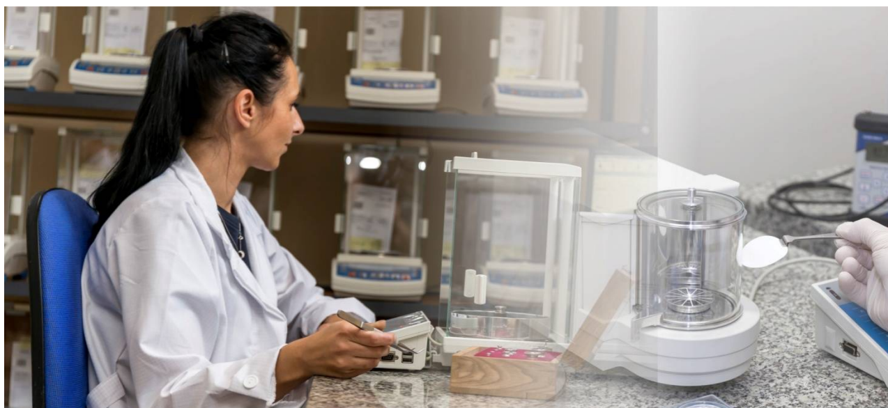
Rysunek 27. Kontrola dokładności wskazań z wykorzystaniem wzorców masy – dział QC Radwag Pomiar masy filtra jako ocena jakościowa wagi dla aplikacji laboratoryjnej
