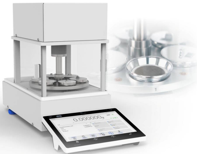
Rysunek 36. Pomiar masy filtrów AK-6 5Y.F , Działka elementarna d=1 \times 10^{-6} g lub d=1 \times 10^{-7} g, Praca automatyczna lub półautomatyczna, Średnica filtra \phi 25 \div 47 mm, Zgodność z PN-EN 12341:2024
