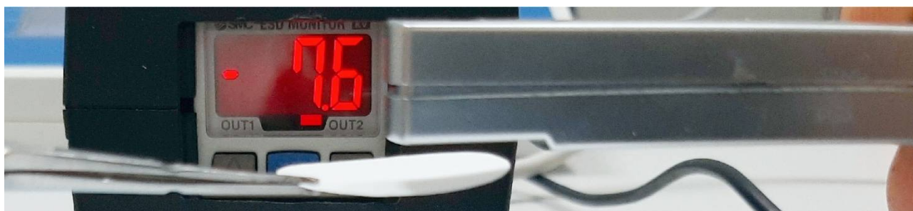
Rysunek 52. Pomiar ładunków elektrostatycznych na filtrze, miernik SMC typu IZD10-510
