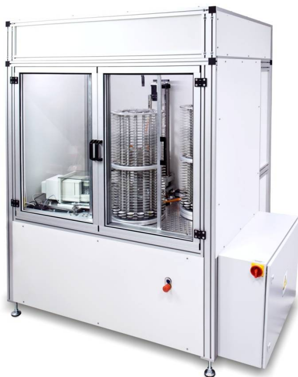
Rysunek 43. System robotyczny RB 2.5Y.F , Maksymalne obciążenie 2g, działka elementarna d=1 \times 10^{-6} g, Magazyn filtrów 1020szt., regulowana temperatura 20 \pm 1^{\circ}\text{C} , wilgotność 45 \pm 5\% . Zgodność z PN-EN 12341:2024
