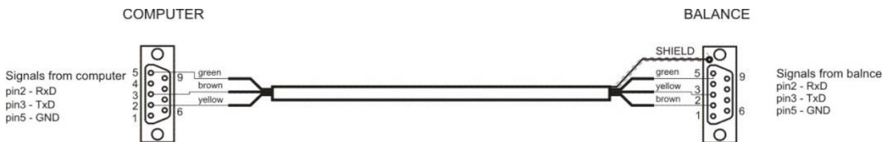
P0108 Esquema de conducto, balanza - ordenador (RS232)
